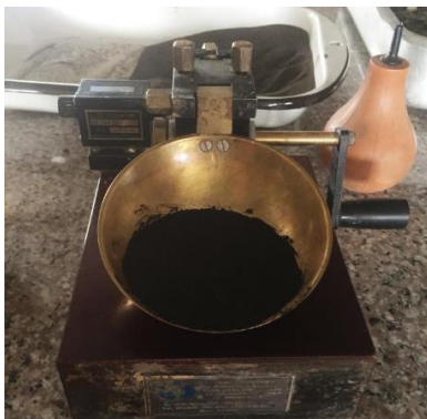
Ilustración 27. Colocación del material en la cuchara de casa grande.
