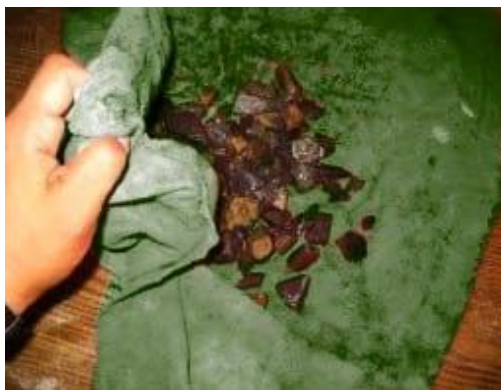
Ilustración 20. Secado superficialmente del agregado grueso.
