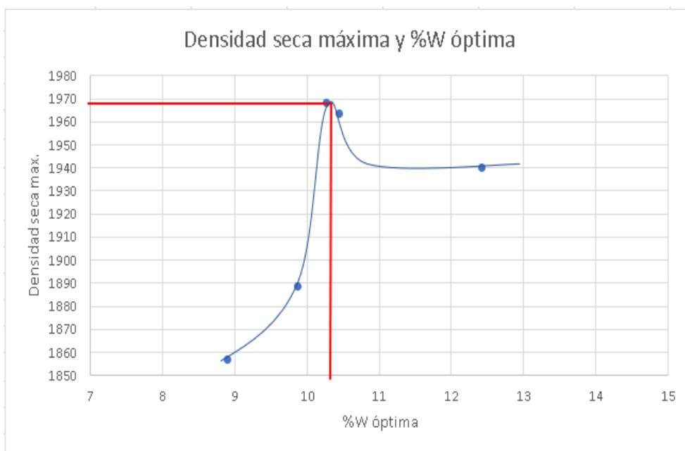
Ilustración 85. Densidad seca máxima y porcentaje de humedad óptima, Av. Gonzáles Suárez.
