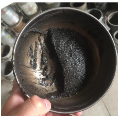
Ilustración 26. Material pasante de la malla N°40 saturado.
