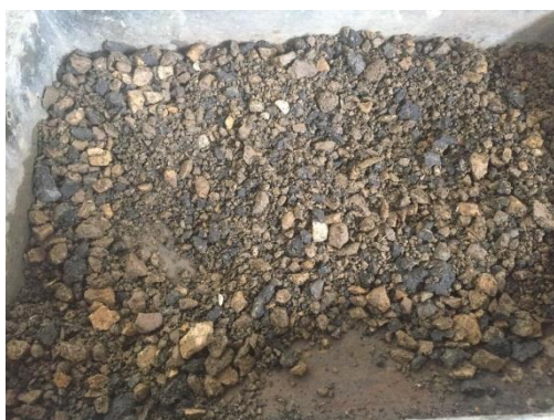
Ilustración 57. Material mezclado uniformemente con una determinada cantidad de agua.
