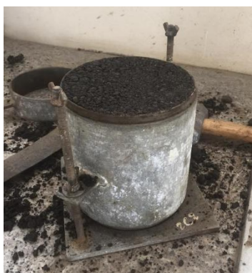
Ilustración 40. Molde sin collarín y con el material engrazado.
