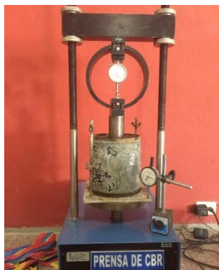
Ilustración 42. Ensayo de CBR y toma de lecturas de carga.
