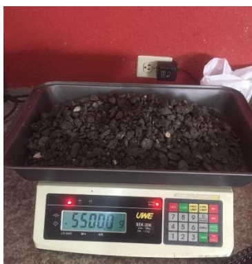
Ilustración 33. Pesaje de material y elaboración de bolsas necesarias para el ensayo.
