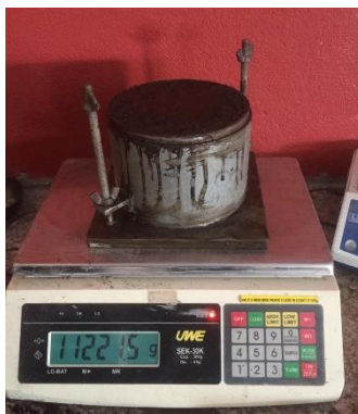
Ilustración 38. Pesaje del molde sin collarín y con el material previamente enraizado.
