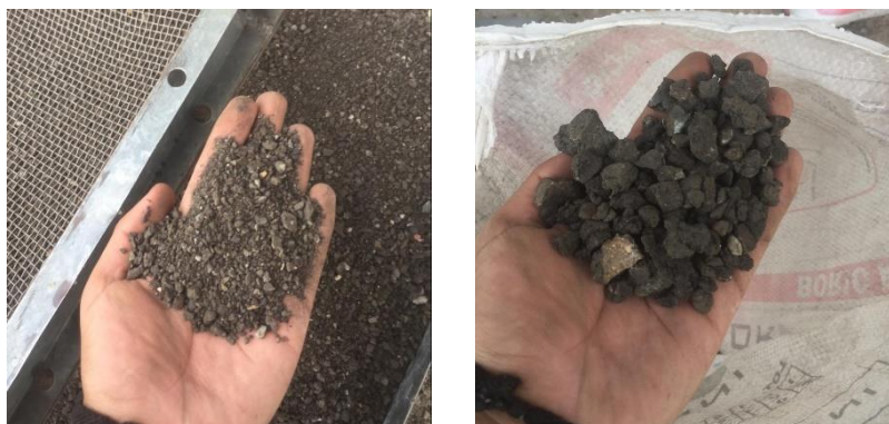
Ilustración 35. Agregado fino y grueso para el ensayo de compactación.
