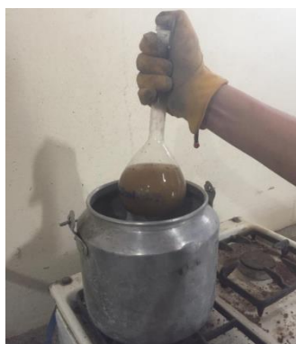
Ilustración 24. Baño maría para la eliminación de contenido de aire.
