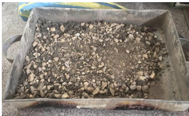
Ilustración 60. Mezcla homogénea de los materiales previo al ensayo de compactación.
