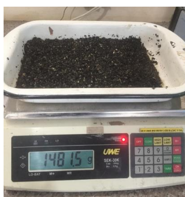
Ilustración 25. Pesaje del material escurrido previo a la colocación en el horno.
