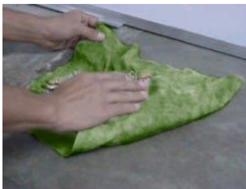
Ilustración 49. Secado superficialmente del agregado grueso luego de la saturación.
