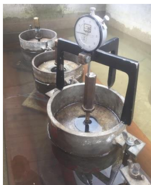
Ilustración 58. Toma de lecturas para determinar el esponjamiento.
