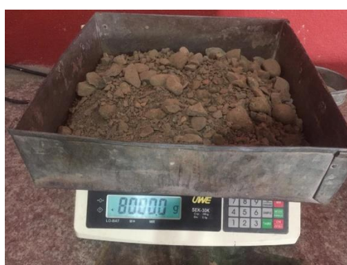
Ilustración 46. Recolección de los 8000 gramos de material para la granulometría de agregados gruesos.
