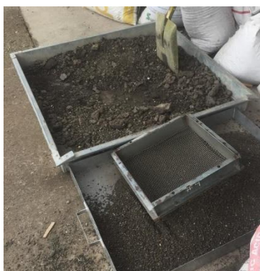
Ilustración 34. Tamizado de la muestra para la obtención de agregado fino y grueso.
