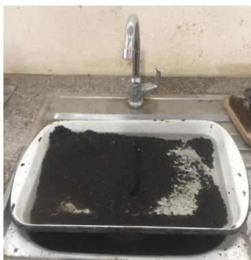
Ilustración 8. Lavado del material para el ensayo de granulometría de agregados finos.
