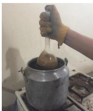
Ilustración 52. Baño maría para la eliminación del contenido de aire.
