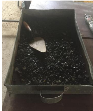
Ilustración 36. Mezcla homogénea de los materiales previo al ensayo.
