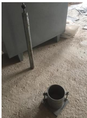
Ilustración 32. Herramientas para el ensayo de compactación.
