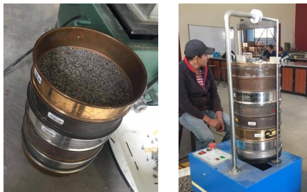
Ilustración 9. Tamizado de agregados finos.
