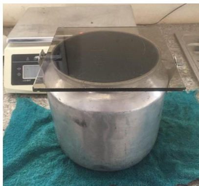
Ilustración 22. Enraizado del molde que contiene material y agua, con ayuda de un vidrio.
