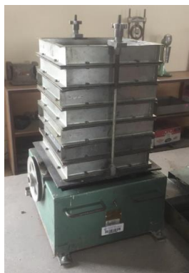
Ilustración 7. Máquina de tamizado de agregados gruesos.
