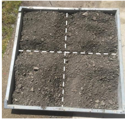
Ilustración 5. Cuarteo de la muestra previamente mezclada.
