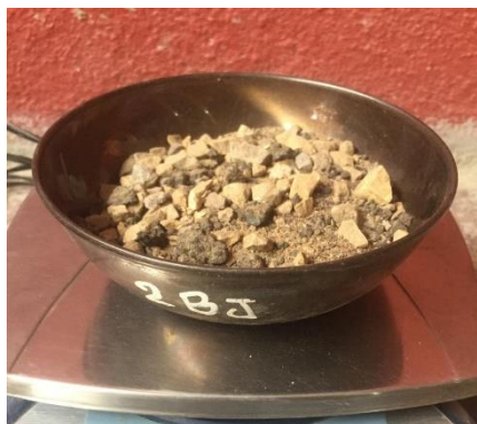
Ilustración 55. Muestra seca luego de ser colocada en el horno.
