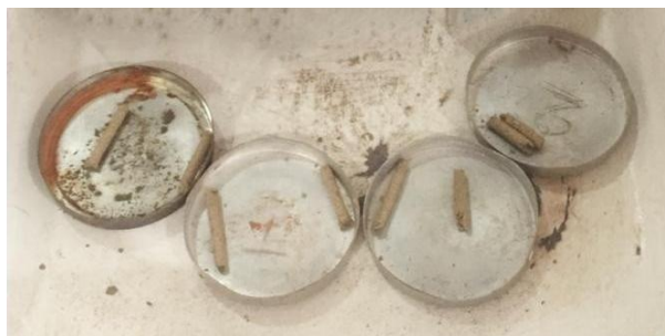
Ilustración 31. Muestras ensayadas luego de ser secadas en el horno.
