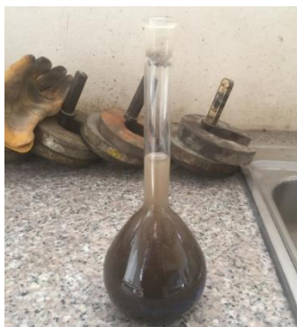
Ilustración 51. Colocación del agregado fino y agua en el picnómetro.
