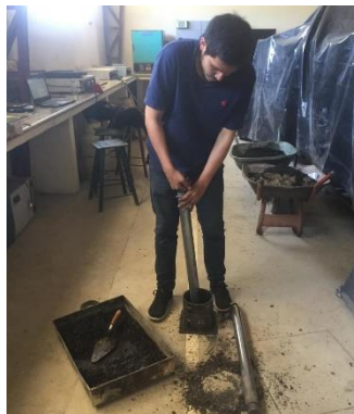
Ilustración 37. Compactación de cada espécimen según lo especificado.
