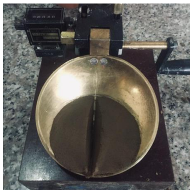
Ilustración 28. Surco en el centro de la porción de material previo al ensayo.
