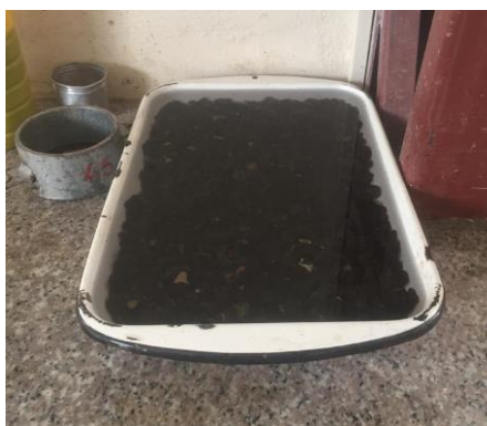
Ilustración 19. Agregado grueso de H°.A. reciclado en proceso de saturación.
