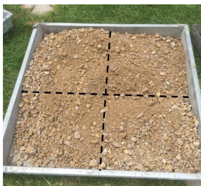
Ilustración 45. Mezclado y cuarteo de la base granular.
