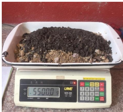
Ilustración 56. Pesaje de los 5500 gramos de hormigón asfáltico reciclado con base granular.
