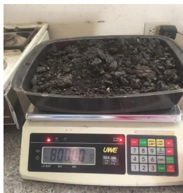
Ilustración 6. Toma de 8000 gr. de material para el ensayo de granulometría.
