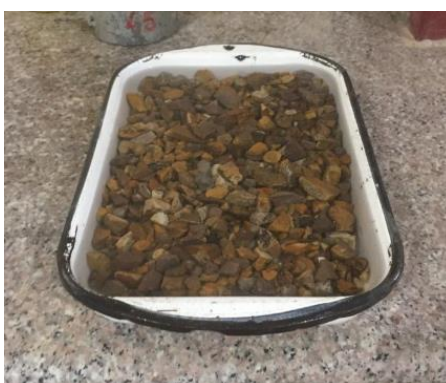
Ilustración 48. Saturación de agregado grueso.
