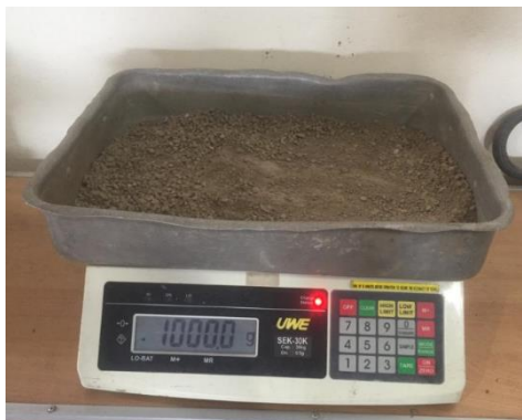
Ilustración 47. Recolección de 1000 gramos de material fino pasante el tamiz N°4 para la granulometría de los agregados finos.
