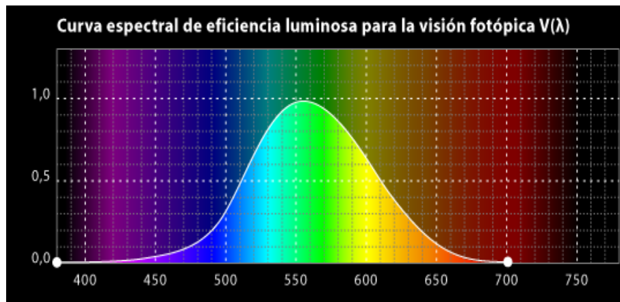
Fig. 5 Curva espectral de eficiencia luminosa para la visión fotópica Fuente: (Boscarol, 2007)
