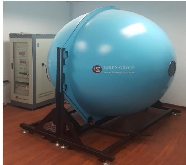
Fig. 14 Esfera Integradora de Ulbricht Fuente: Propia
