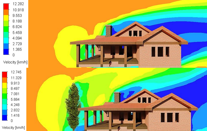
Figura 22. Comparaciones de impacto de viento sin, y con la barrera de álamo.
