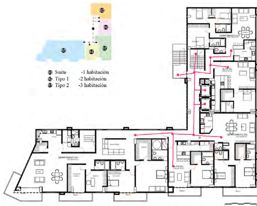
FIGURA 3.18: Primera Planta Alta del Conjunto Habitacional "Terrazas al Río", Flexibilidad Habitacional en los Retiros ante la Creación de Terrazas y Balcones.
