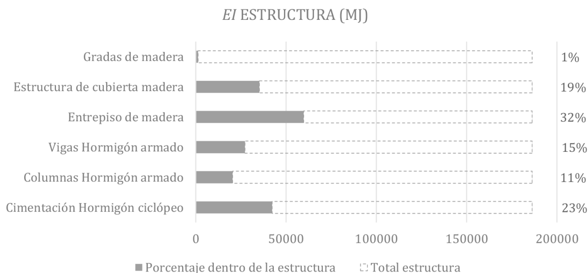
FIGURA 4.7: Energía Incorporada distribuida en porcentaje de los elementos que conforman la componente de Estructura de la vivienda del periodo 1.
