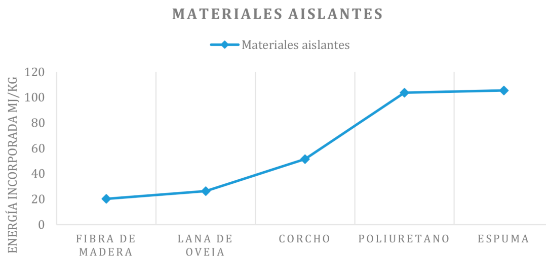
FIGURA 2.6: Incremento de Energía Incorporada entre materiales aislantes de origen natural y sintéticos. Elaboración propia con datos de Zabalza et al., 2011
