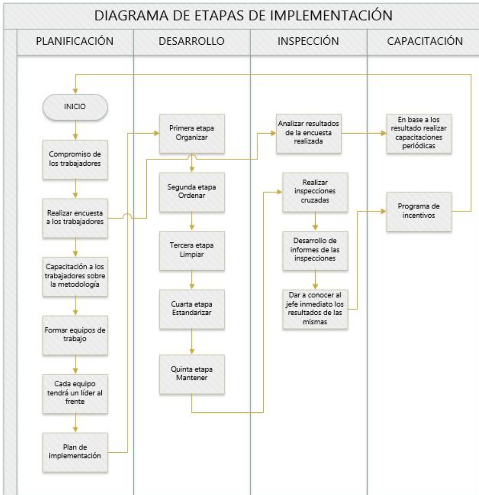
Gráfico 28: Diagrama de Flujo de las Etapas de Implementación de la Metodología 5'S Elaboración: Autor
