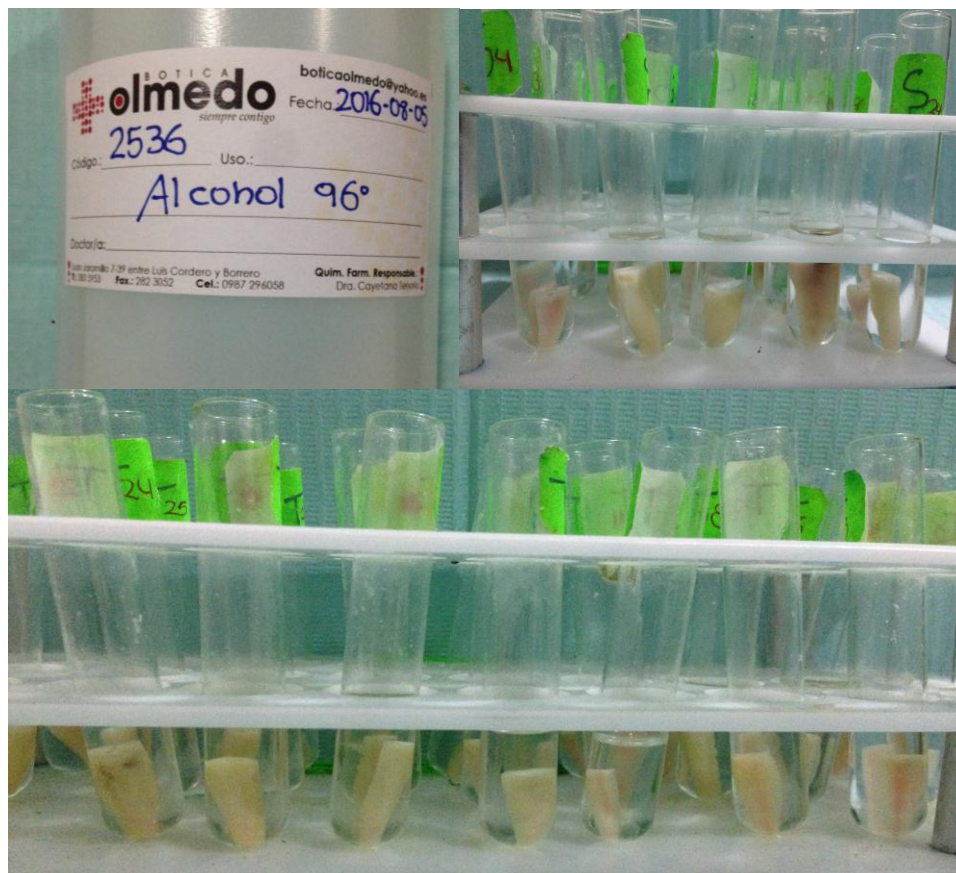
Figura 20. Deshidratación. Piezas dentarias en Alcohol Eílico al 96% por 3 horas.
