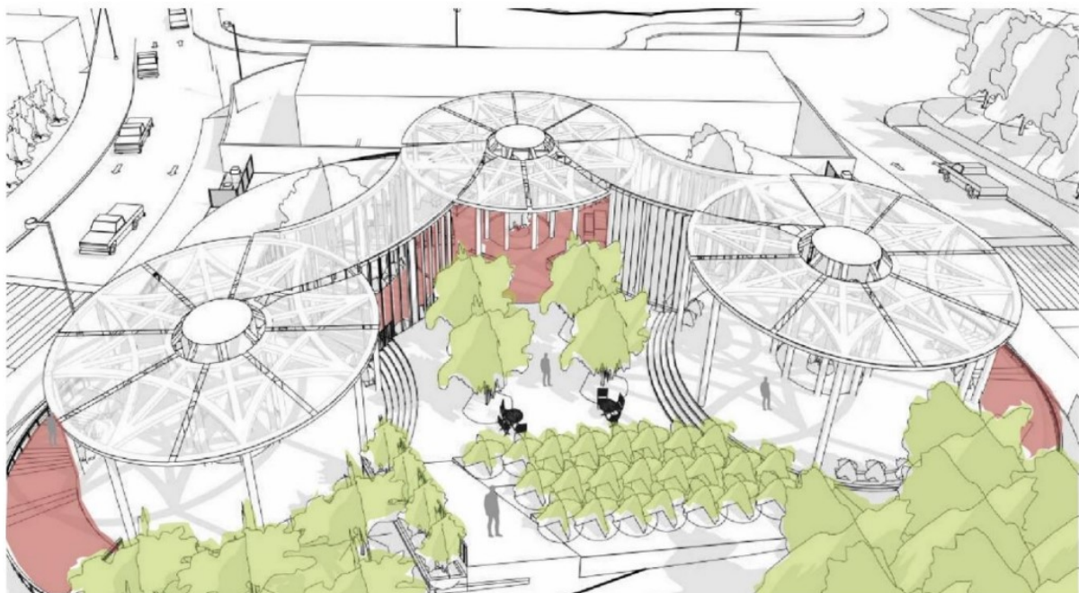
FIGURA 3.24: Estructura metálica y cubiertas de policarbonato. Fuente: Elaboración propia.
