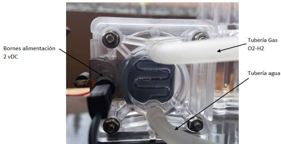
Ilustración 7. Electrolizador Tipo PEME de una celda en el laboratorio CER Fuente: Autor
