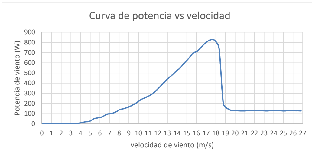
Figura 34. Curva de Relación Velocidad de viento vs potencia generada Fuente: Air 403 Power Manual
