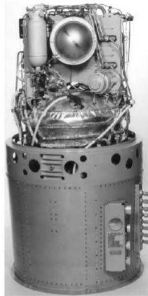
Figura 7. Pila combustible utilizada en nave espacial Apollo.
