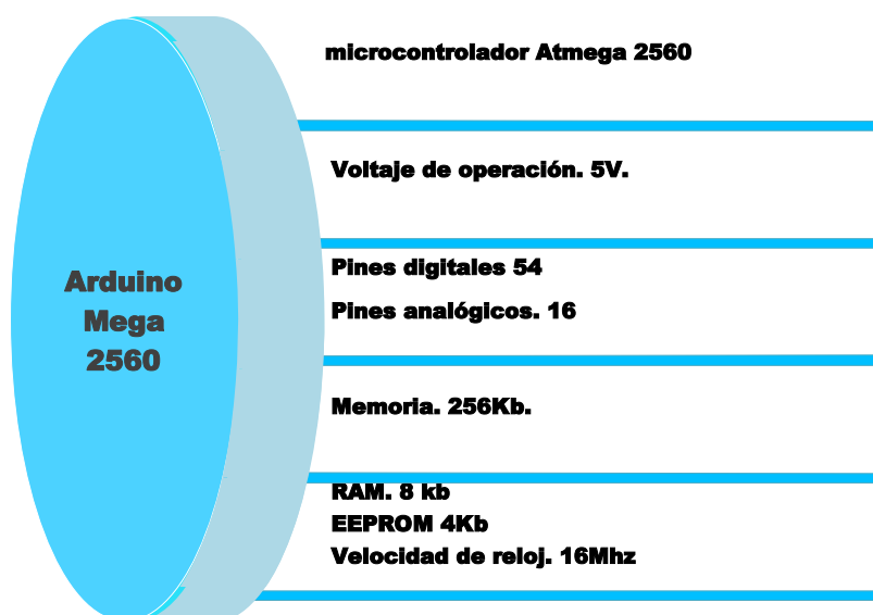
Figura 19. Especificaciones de la tarjeta Arduino Mega 2560. Fuente: ("Arduino - Home," 2005)
