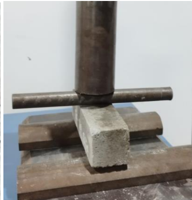
Anexo 36. Rotura de muestra a flexión con 1.5% de fibra
