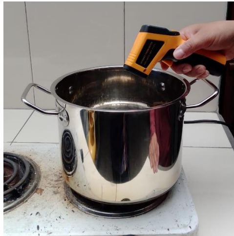
Anexo 16. Medidor de temperatura, 250 °C y fundición del PET
