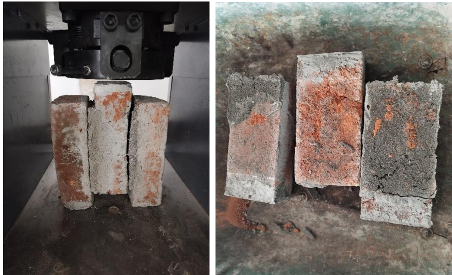
Anexo 33. Rotura y falla del mortero de la muestra de adherencia por corte con 1% de fibra
