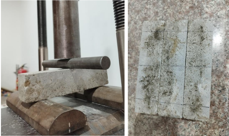
Anexo 32. Rotura de muestra a flexión con 1% de fibra
