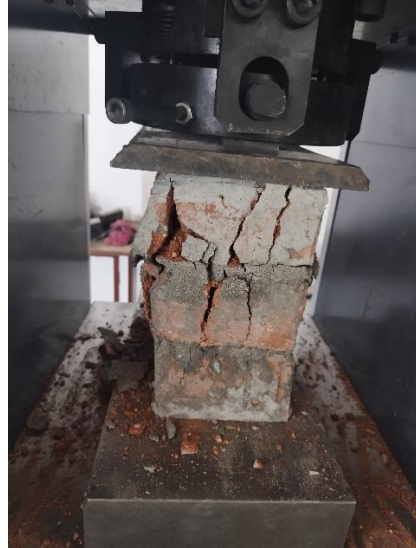
Anexo 35. Rotura de muestra a compresión del mortero con 1.5% de fibra
