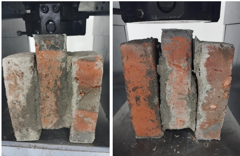
Anexo 37. Rotura y falla del mortero de la muestra de adherencia por corte con 1.5% de fibra
