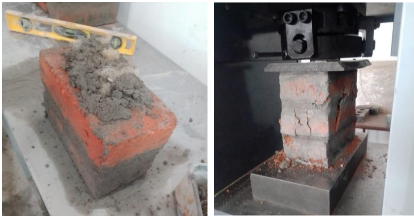
Anexo 30. Elaboración y rotura de prismas de mampostería con 0.5% de fibra
