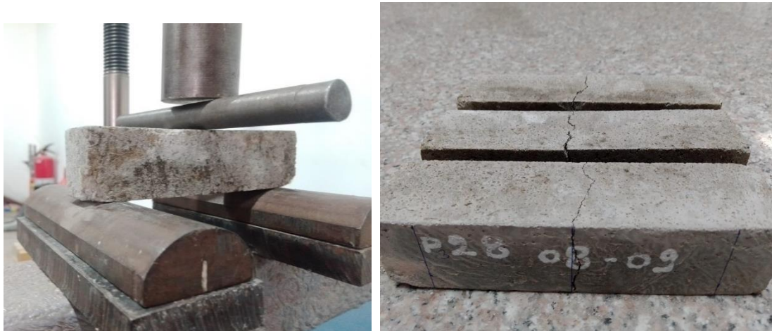
Anexo 28. Rotura de muestra a flexión con 0.5% de fibra
