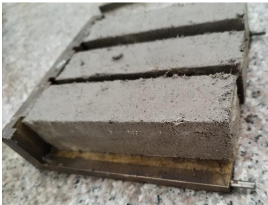
Anexo 36. Rotura de muestra a flexión con 1.5% de fibra
