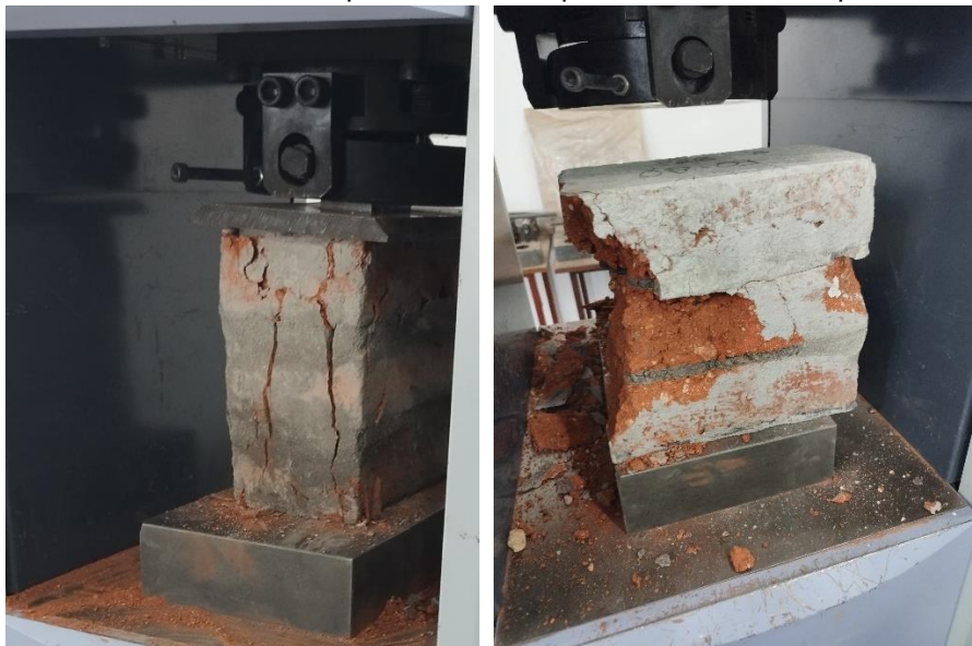
Anexo 26. Rotura de prismas de mampostería con mortero patrón
