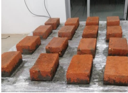
Anexo 21. Refrendado de las muestras del ensayo de prismas de mampostería
