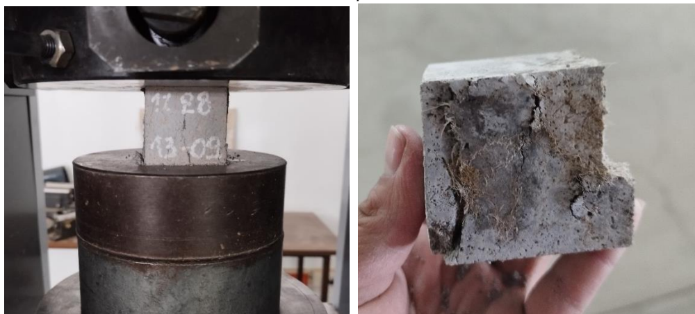
Anexo 31. Rotura de muestra a compresión del mortero con 1% de fibra
