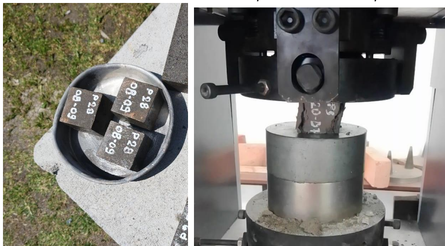
Anexo 23. Rotura de muestra a compresión del mortero patrón
