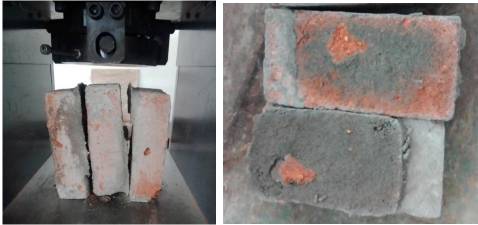
Anexo 30. Elaboración y rotura de prismas de mampostería con 0.5% de fibra
