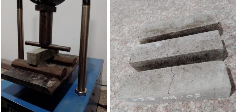
Anexo 24. Rotura de la muestra patrón a flexión
