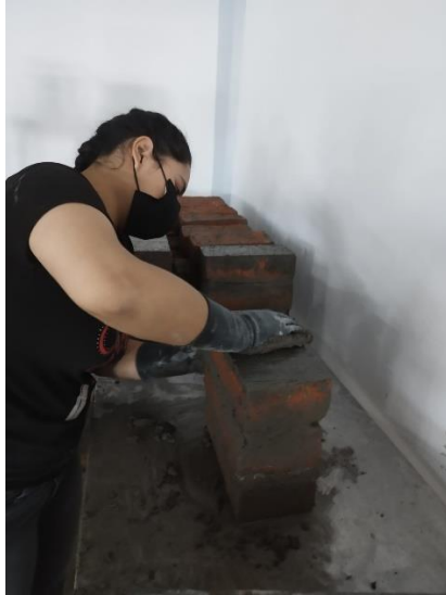
Anexo 35. Rotura de muestra a compresión del mortero con 1.5% de fibra
