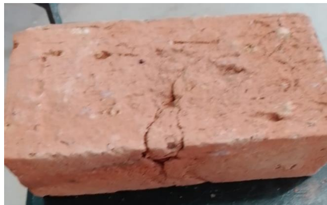
Anexo 20. Plano de falla en un ladrillo
