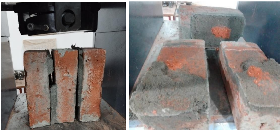
Anexo 25. Rotura y falla del mortero patrón de la muestra de adherencia por corte
