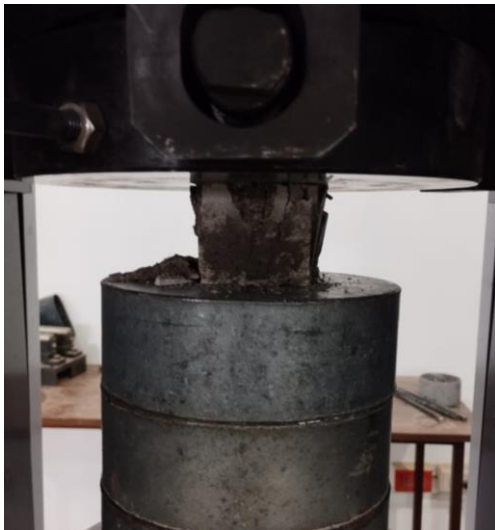
Anexo 35. Rotura de muestra a compresión del mortero con 1.5% de fibra
