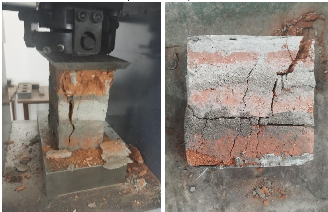
Anexo 38. Rotura de prismas de mampostería con 1.5% de fibra
