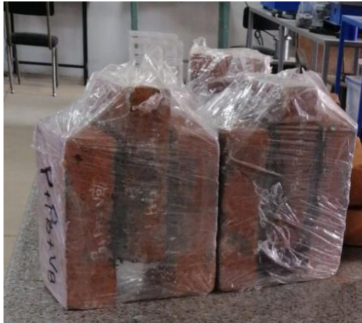
Anexo 22. Curado de las muestras del ensayo de adherencia por corte
