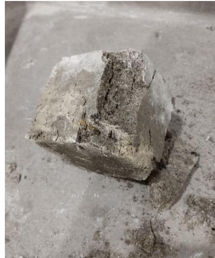
Anexo 35. Rotura de muestra a compresión del mortero con 1.5% de fibra
