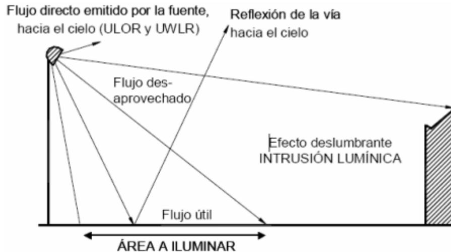
Figura 8 Flujo de luz producido por una luminaria.
