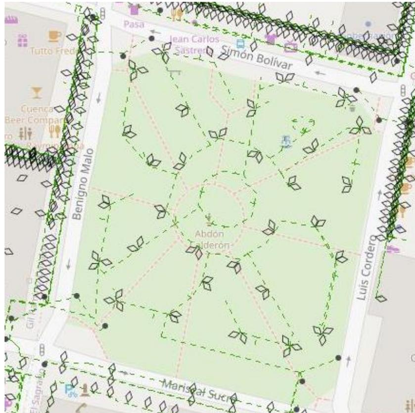
Figura 26 Ubicación y disposición de luminarias dentro del Parque Calderón de la ciudad de Cuenca.
