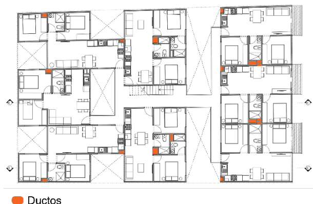
Figura 17: Ductos unificados de servicios
