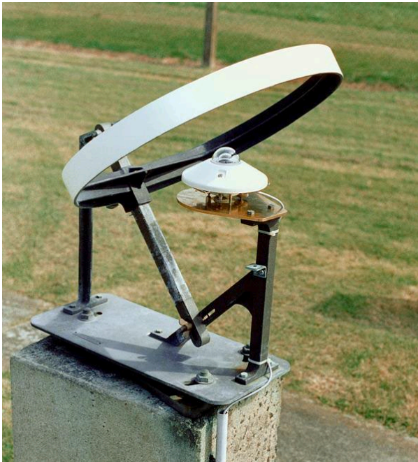
Figura 6: Pirómetro Con banda de Sombra Para la Medición Radiación Difusa
