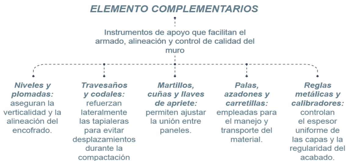
Figura 21. Elementos del tapial
