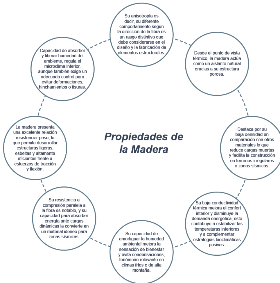
Figura 34. Propiedades físicas, térmicas y mecánicas de la madera.
