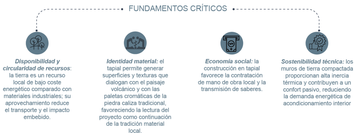
Figura 31. Fundamentos críticos del sistema constructivo en tierra.
