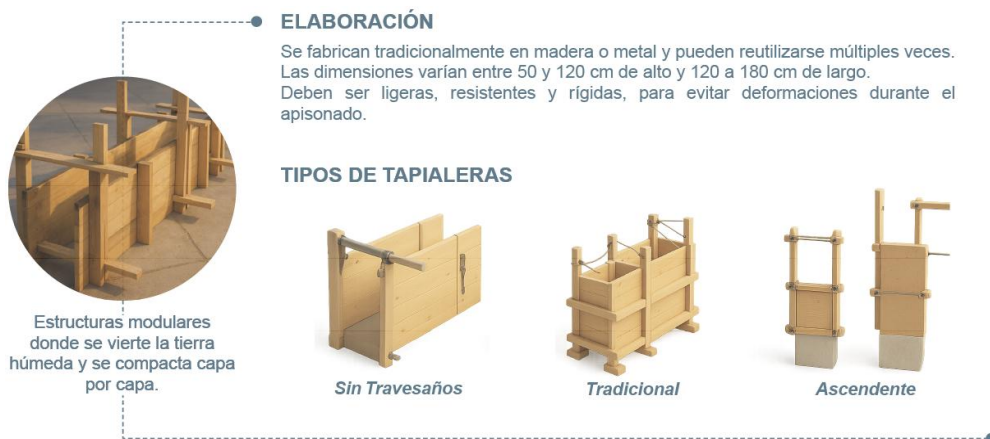
Figura 19. Sistemas de encofrado para muros de tapial.
