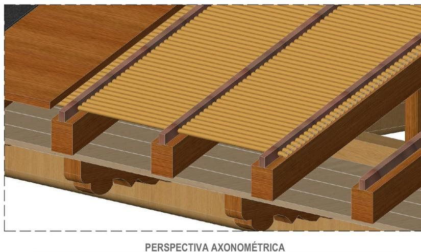
FIGURA 3.34: *Detalle 7: Propuesta de anclaje de tablero OSB*
