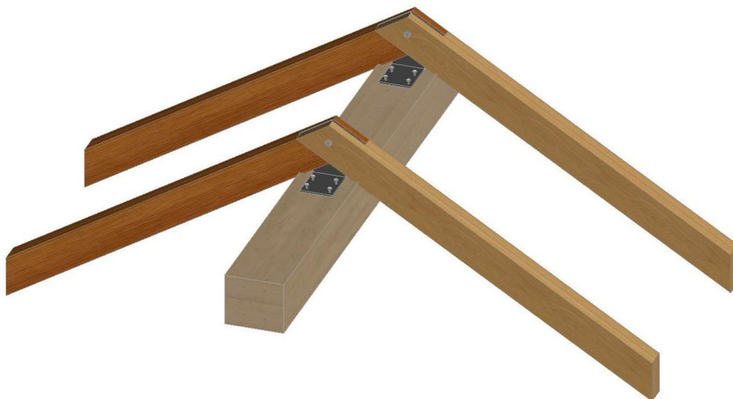
FIGURA 3.22: *Detalle D10: Ensamble pares de cubierta*
