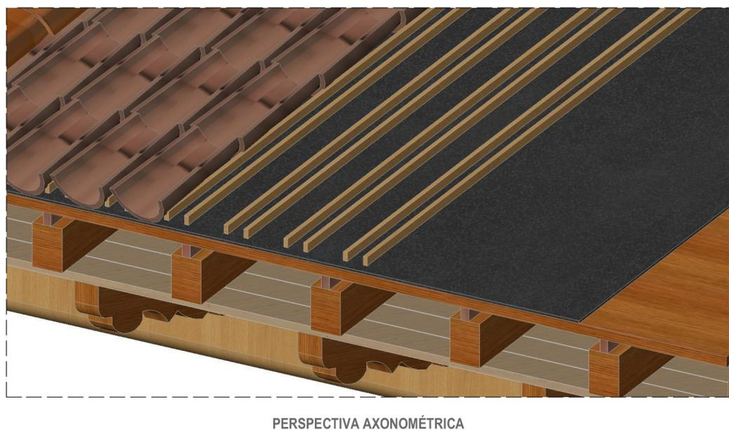
FIGURA 3.32: *Detalle 5: Propuesta de anclaje de tirillas*
