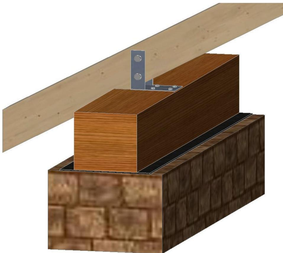
FIGURA 3.24: *Detalle D12: Ensamble par de cubierta-viga solera*
