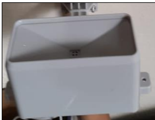
Ilustración 12. Sensor pluviómetro. Fuente: Autores.
