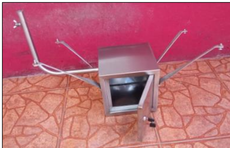
Ilustración 61. Caja metálica de la estación meteorológica en acero inoxidable. Fuente: Autores.
