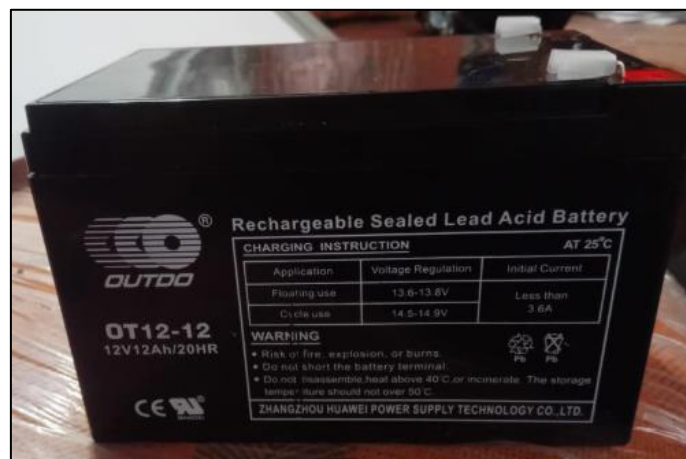
Ilustración 70. Batería sella de plomo ácido de 12V/12Ah. Fuente: Autores.
