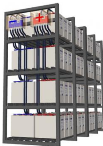
Figura 36. Banco de baterías Fuente: (www.amperonline.com)
