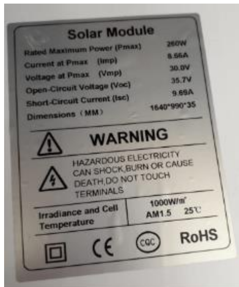
Figura 43. Datos de placa de los módulos fotovoltaicos (CER) Fuente: Centro de energías renovables de la universidad católica de Cuenca
