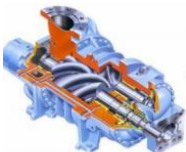
Figura 15. Esquema de un compresor tipo tornillo Fuente: (Ruiz, 2016)
