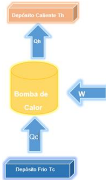
Figura 2. Diagrama esquemático de una bomba de calor Fuente: Autor
