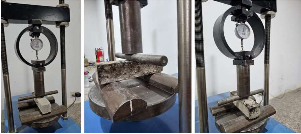
Figura 24. Probetas con forma de vigueta sometidas a ensayos por flexión
