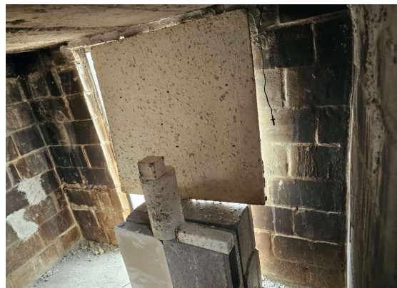
Figura 27. Colocación de muestras en el horno refractario
