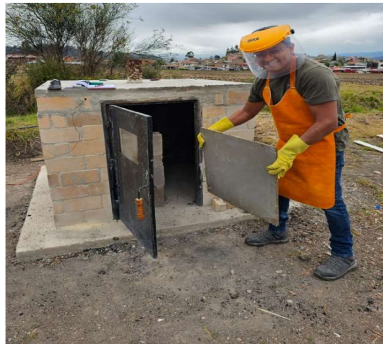
Figura 26. Ingreso de las muestras en el horno refractario
