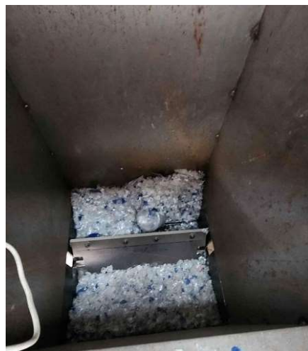
Figura 14. Trituración de las botellas de plástico PET
