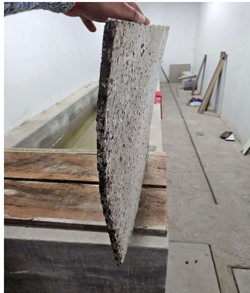
Pandeo del Panel expuesto al fuego durante 15 minutos
