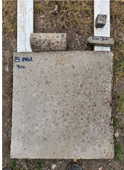
Panel expuesto al fuego durante 15 minutos
