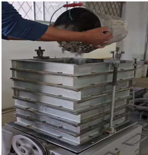
Figura 16. Tamizado de las partículas de plástico PET
