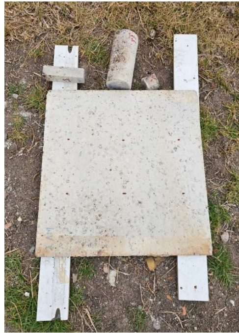
Panel expuesto al fuego durante 5 minutos
