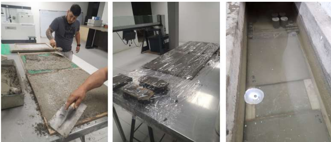
Figura 22. Plastificación, desencofrado y curado de las muestras
