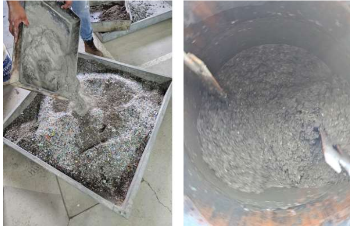
Figura 20. Elaboración de la mezcla homogénea compuesta por materiales granulares y agua
