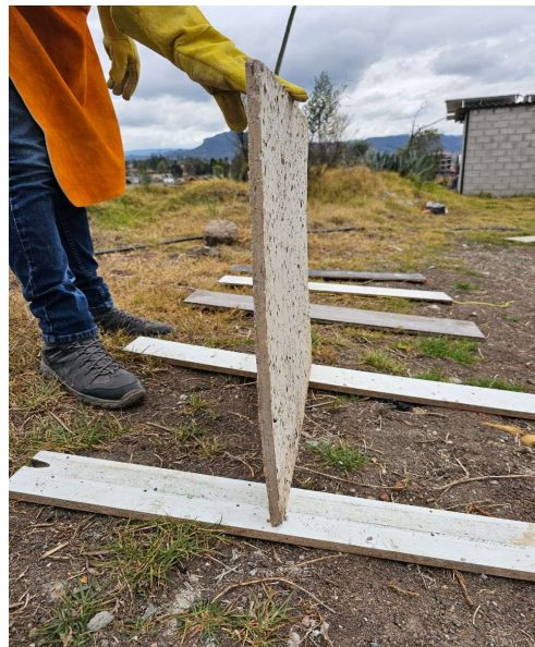
Pandeo del Panel expuesto al fuego durante 5 minutos
