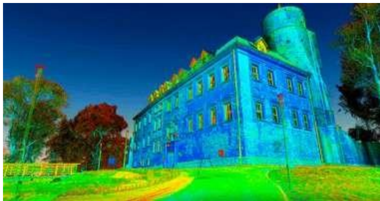
FIGURA 3.3: Utilización de scanner para la obtención de información del estado actual de la Fabra i Coats.
