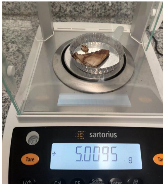
Figura 24 Medición de 5g de micelio por medio de la balanza analítica
