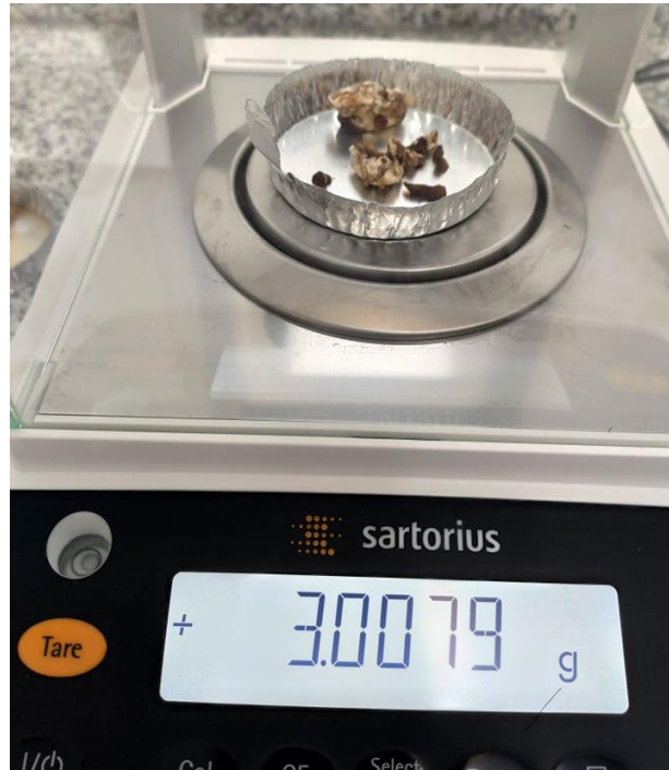
Figura 22 Medición de 3g de micelio por medio de balanza
