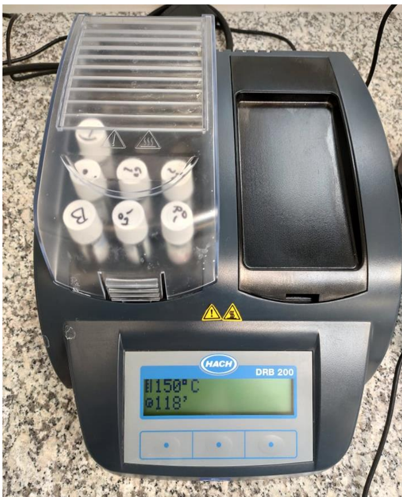
Fotografía del equipo y las muestras de agua residual en el análisis de DQO. Figura 34 Análisis DQO de las muestras de agua
