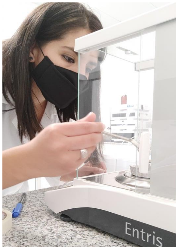
Figura 23 Colocación del micelio en la balanza analítica
