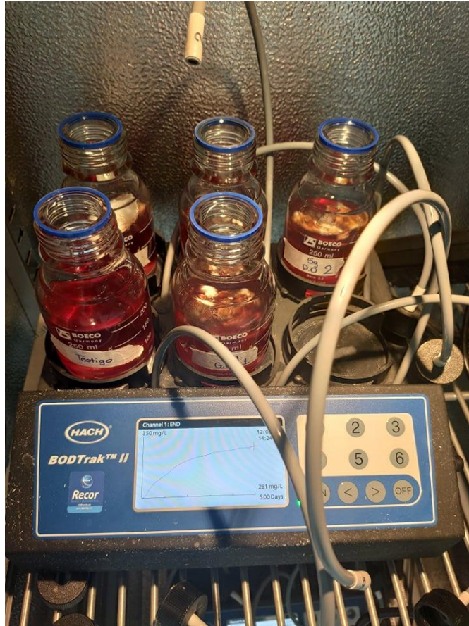
Figura 30 Muestras de agua residual con los hongos Pleurotus ostreatus y Pleurotus citrinopileatus dentro del equipo de laboratorio
