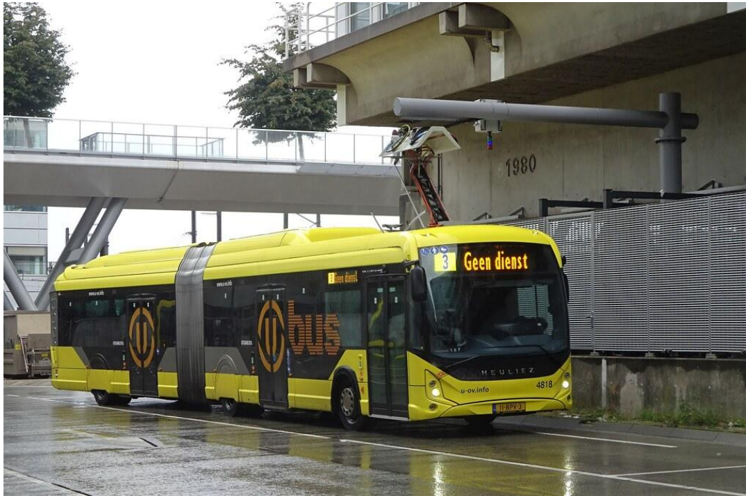
Figura 23: Autobus eléctricos del sistema de transporte público de Utrecht. Fuente: Gemeente Utrecht (2021).
