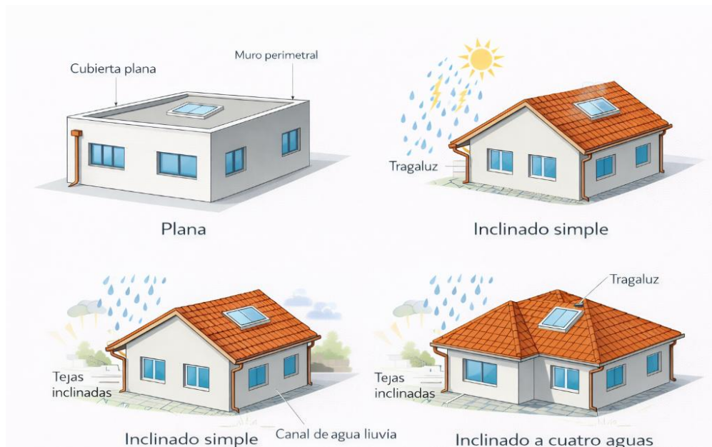
Figura 32: Tipologías de cubiertas predominantes Fuente: Elaboración propia.
