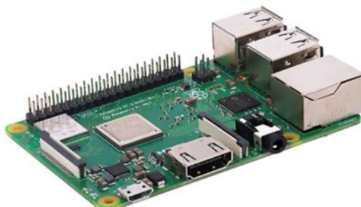
Figura. 33. Raspberry Pi 3. Fuente: (Alx, 2018).
