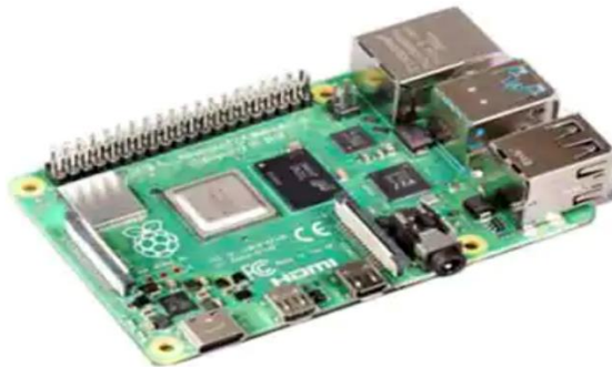
Figura. 34. Raspberry Pi 4. Fuente: (Alx, 2018).
