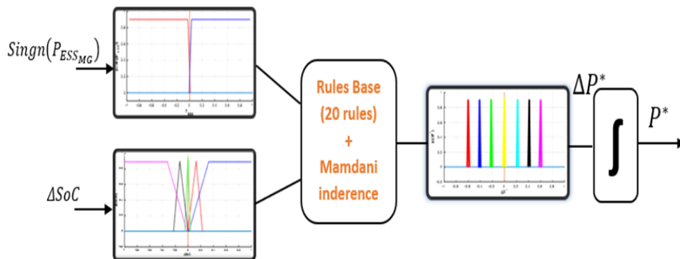
Figura. 15. Esquema de control de control difuso simplificado. Fuente:(Autores)
