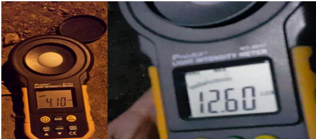
Fig. 48 Rendimiento entre una lámpara LED de 100W y una de sodio de 150W en el estacionamiento de la Universidad Católica de Cuenca ubicado en la Avenida de las Américas y calle Humboldt
