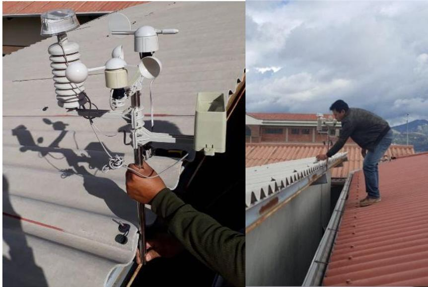
Fig. 27 Estación meteorológica instalada en el lugar de estudio
