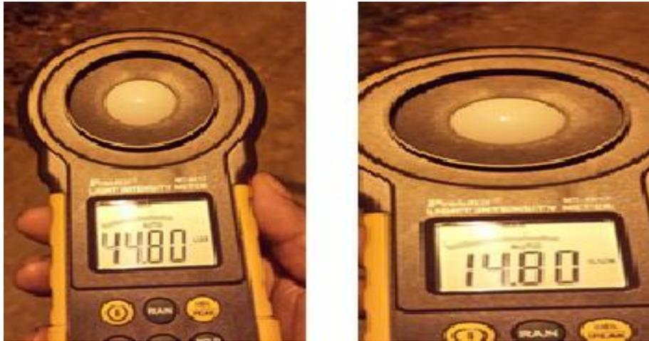
Fig. 47 Lámpara de Sodio a 4 y 9 metros de distancia a la base
