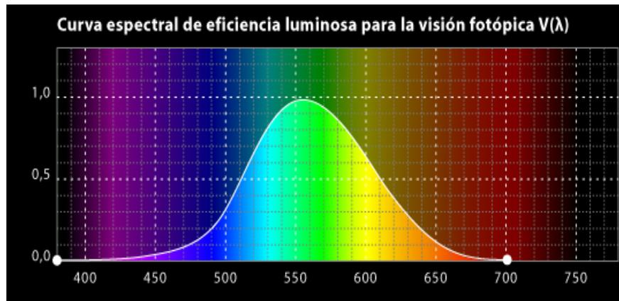
Fig. 17 Parábola espectral de eficiencia luminosa fotópica
