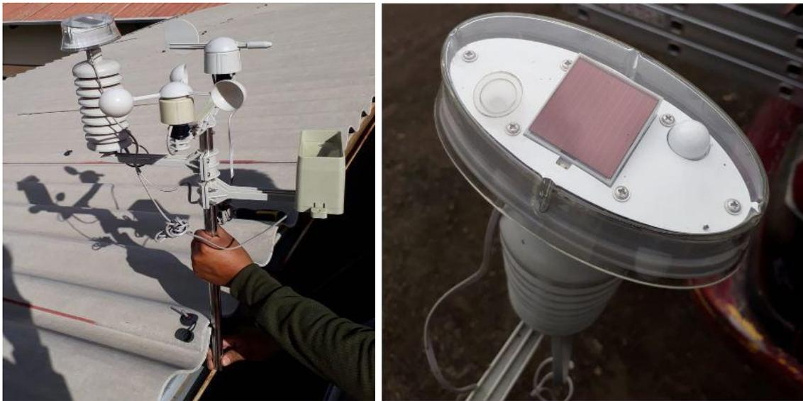
Fig. 34 Colocación de la estación meteorológica con su respectivo piranómetro en el lugar de estudio.
