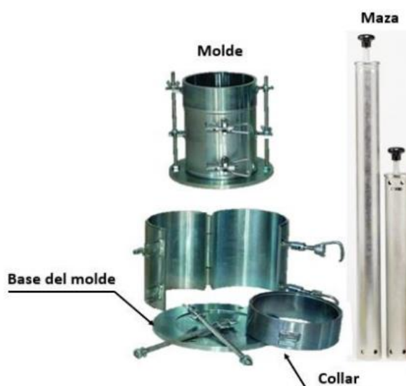
Figura 3: Equipo de laboratorio utilizado para ensayo de compactación. Fuente: (Lopez Maldonado, 2020)
