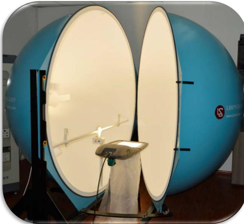
Fig 1. Esfera Integradora perteneciente al Laboratorio de Luminotecnia de la Universidad Católica de Cuenca
