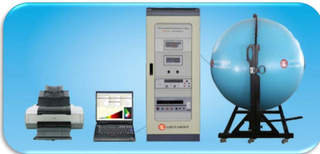
Fig 2. Elementos de medición de la Esfera Integradora
