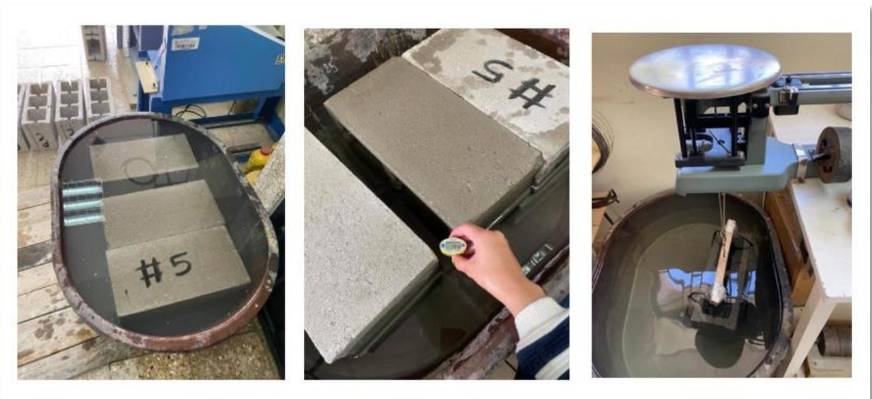
*Figura. 15 Ensayo de saturación.*
