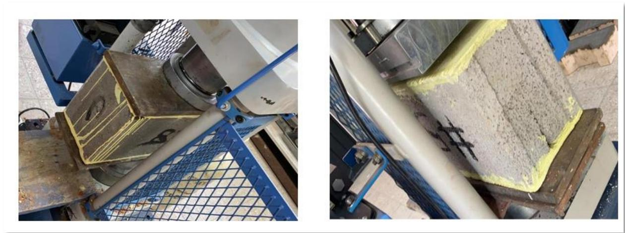
Figura. 17 Ensayo de resistencia mínima a la compresión.
