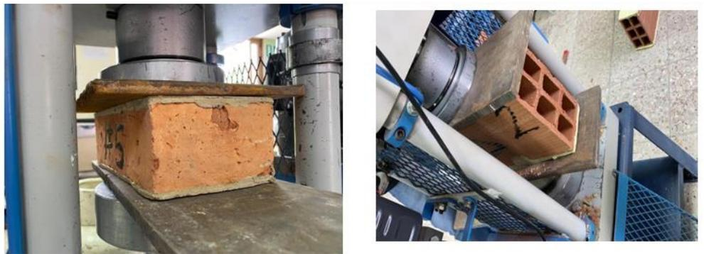
Figura. 30 Ensayo de resistencia mínima a la compresión.
