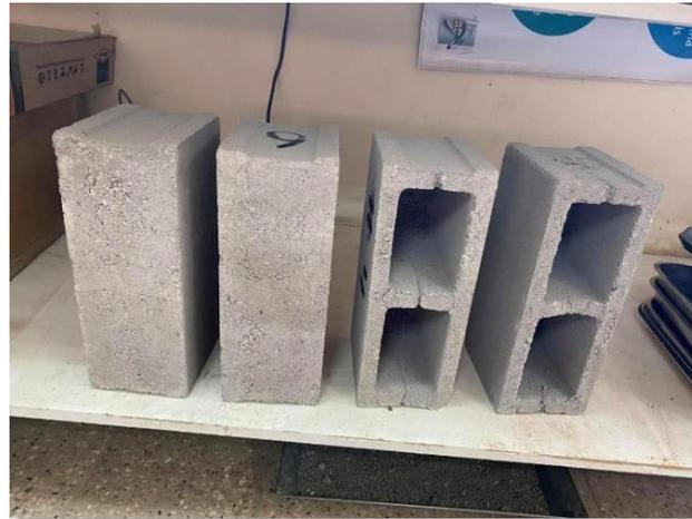
Figura. 16 Muestras después del secado durante 24 horas.
