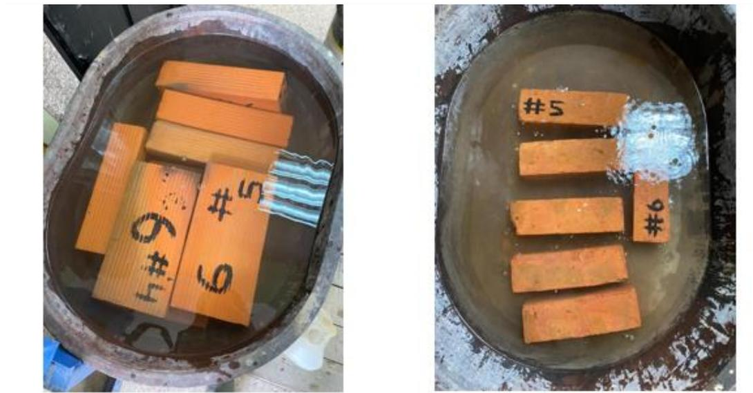
Figura. 29 Ensayo de absorción total
