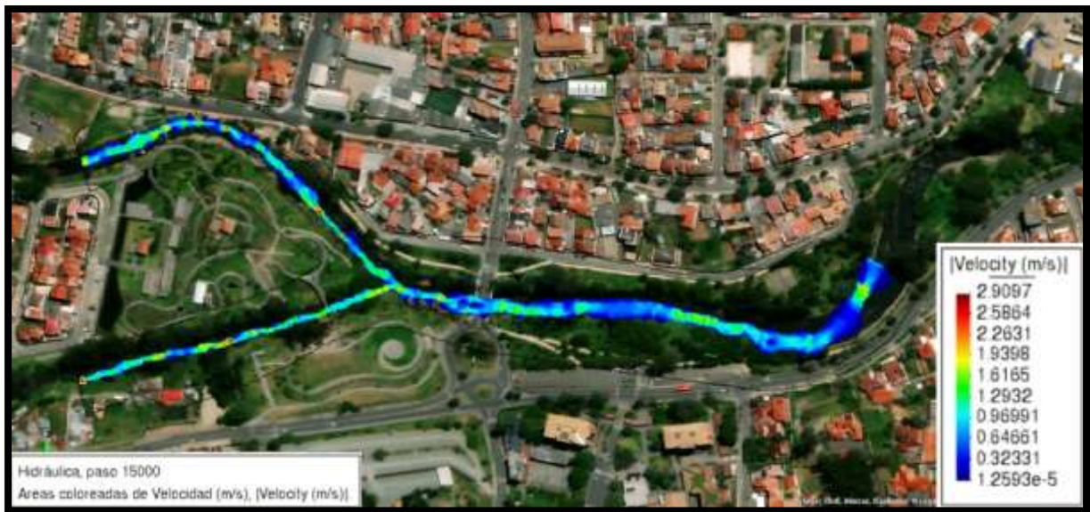
Ilustración 38. Velocidad aplicando rugosidad por fotometría, Caudal de la primera campaña de aforo. (Fuente; Propia)
