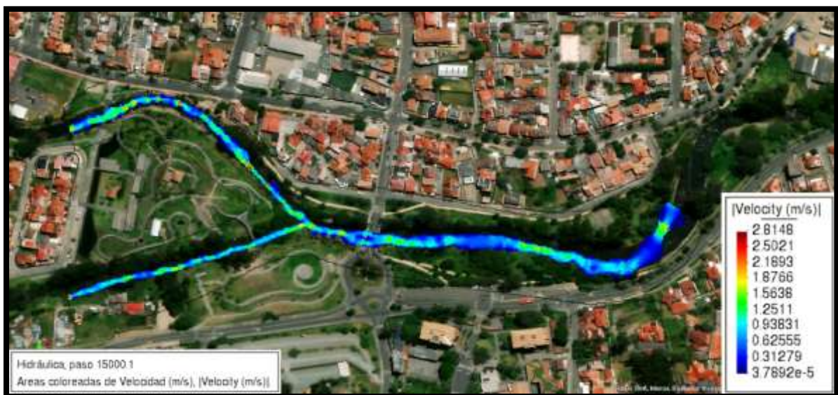
Ilustración 34. Velocidad aplicando rugosidad en medición in situ, Caudal de la primera campaña de aforo.
