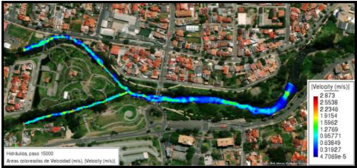
Ilustración 36. Velocidad aplicando rugosidad por análisis granulométrico, Caudal de la primera campaña de aforo. (Fuente; Propia)
