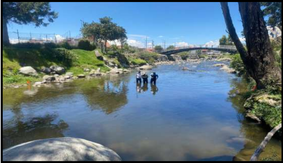
Ilustración 20. Campañas de aforo, medición de caudales y velocidades. (Fuente; Propia)
