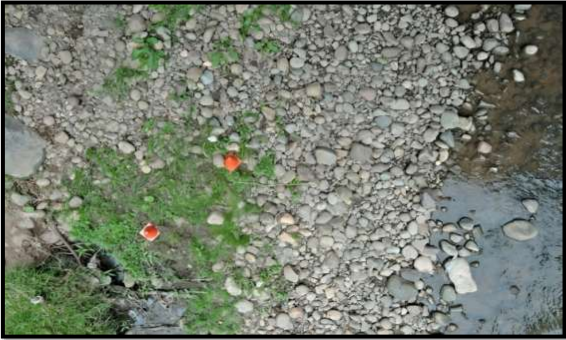
Ilustración 3. Imagen por dron, granulometría Río Tarqui. (Fuente; Propia)
