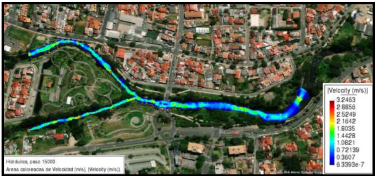
Ilustración 40. Velocidad aplicando rugosidad por fotometría, Caudal de la segunda campaña de aforo. (Fuente; Propia)
