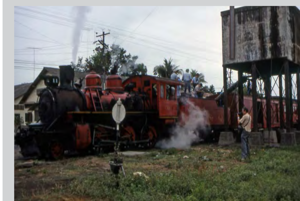
TENDER ABASTECIENDO DE AGUA A LOCOMOTORA DE VAPOR
