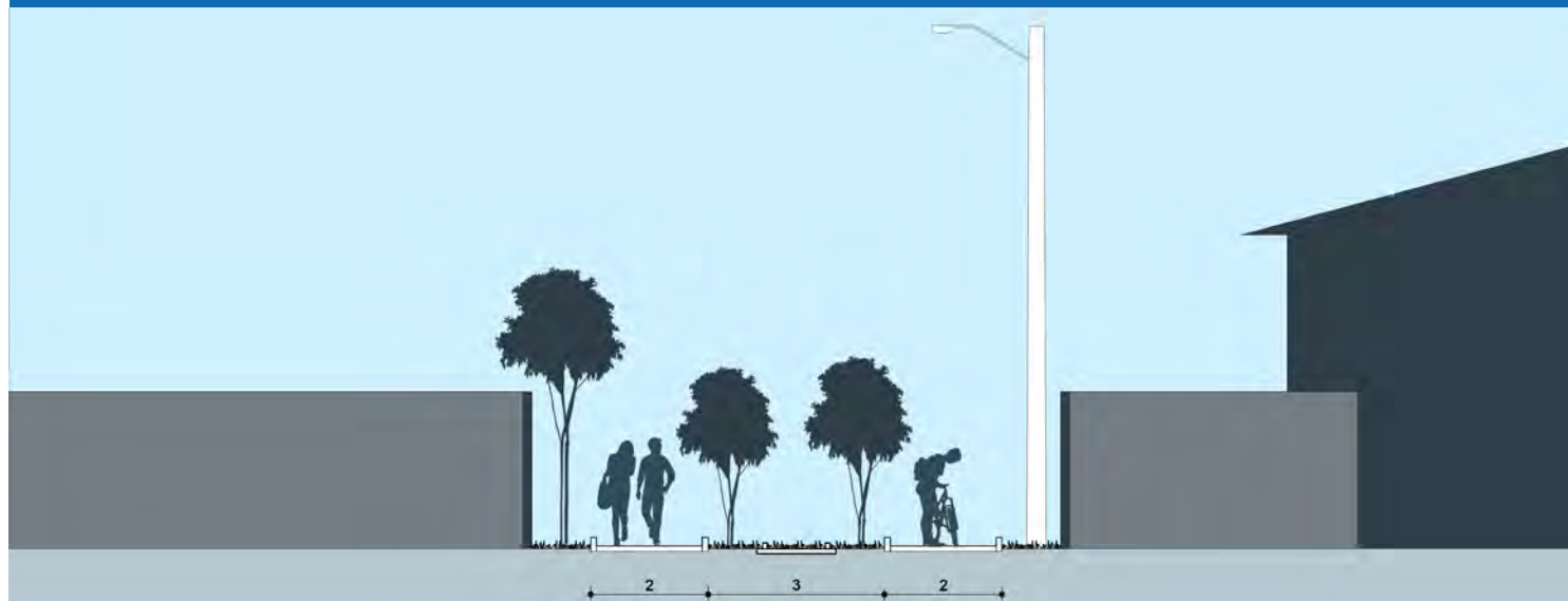
59. Figuras: Sección de vía 2, Ex vía férrea - Actual ciclovía.
