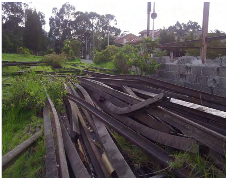
105. Fotografía: Rieles de la vía férrea acumuladas y oxidándose.
