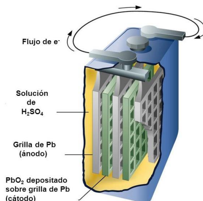
Figura 4. Batería de Pb-acido (Fuente: Pelaez Samaniego, Espinosa Abad, 2015)
