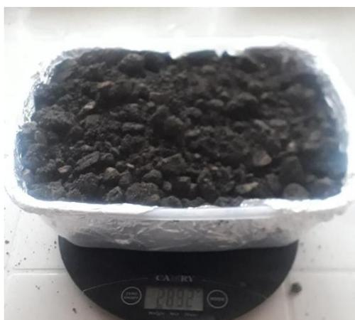
**Figura 22.** Proceso de pesaje del suelo.
