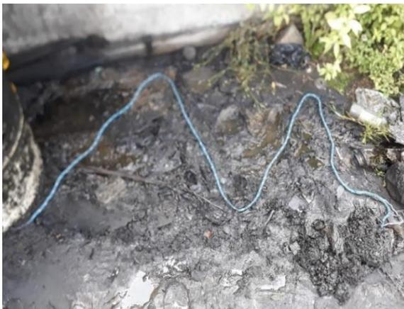
**Figura 18.** Esquema para la recolección de muestras de suelo zig-zag.
