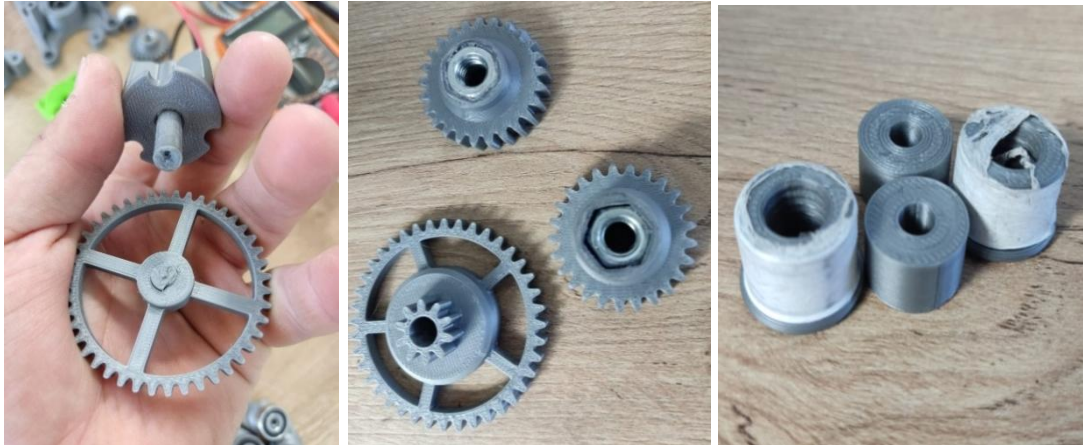
Figura 64: Piezas defectuosas del primer prototipo. Fuente: Elaboración propia.
