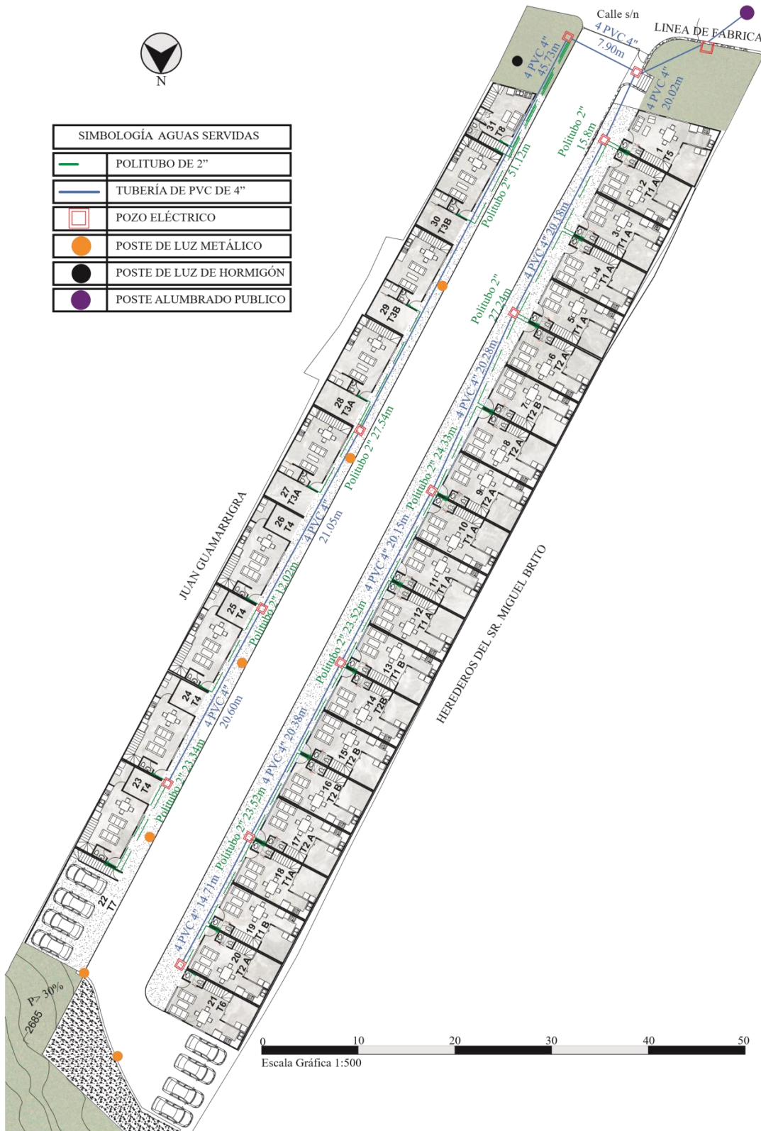
FIGURA 2.43: Plano Sistema Eléctrico Emplazamiento
