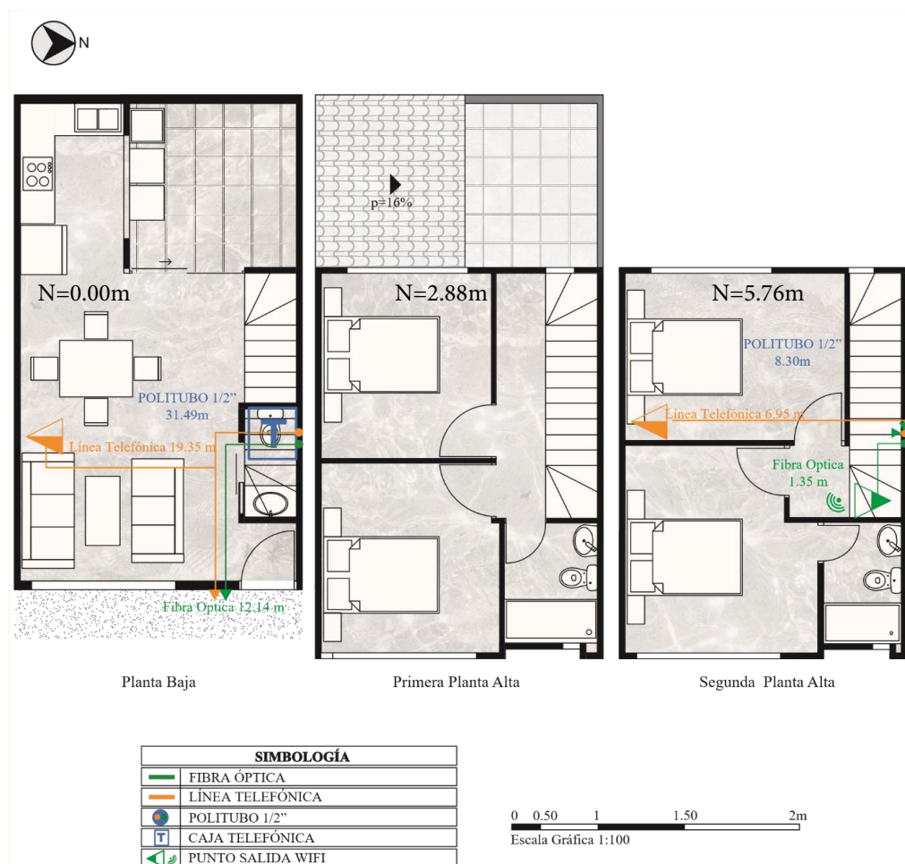
FIGURA 2.70: Plano Sistema telefónico Vivienda Tipo T2A
