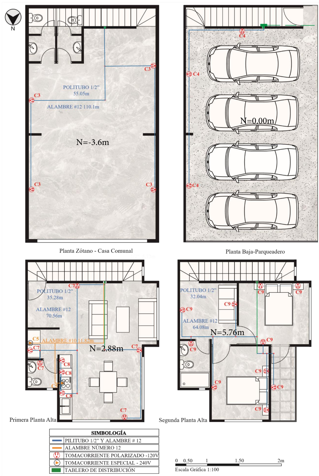
FIGURA 2.62: Plano Sistema de Tomacorriente Vivienda Tipo T7
