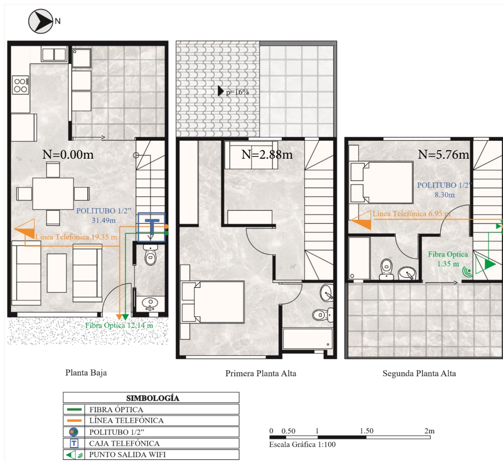
FIGURA 2.69: Plano Sistema telefónico Vivienda Tipo T1B
