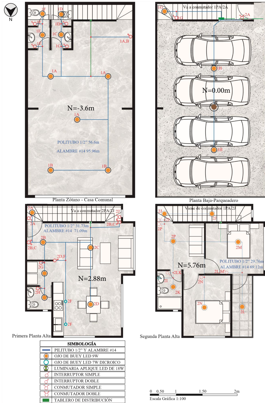
FIGURA 2.61: Plano Sistema de Iluminación Vivienda Tipo T7
