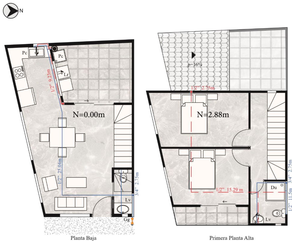
FIGURA 2.26: Plano Sistema Agua Potable Vivienda Tipo T5 1/2
