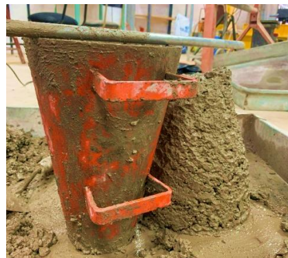
Fig 36: Prueba de Asentamiento
