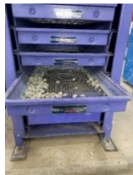
Fig 26: Tamizadora de grava
