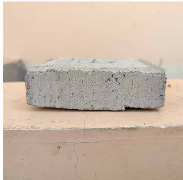
Anexo 16. Muestra de adoquín para ensayos al desgaste de abrasión, con dimensiones 10*10*3 cm
