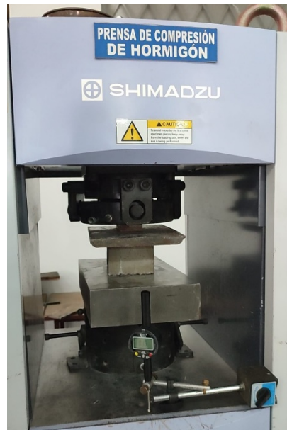
Anexo 13. Ensayo a compresión del adoquín 12% de neumático triturado.
