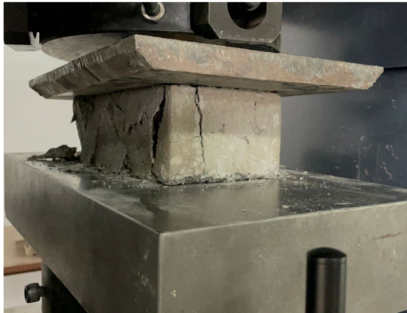
Anexo 15. Ensayo a compresión del adoquín 18% de neumático triturado.
