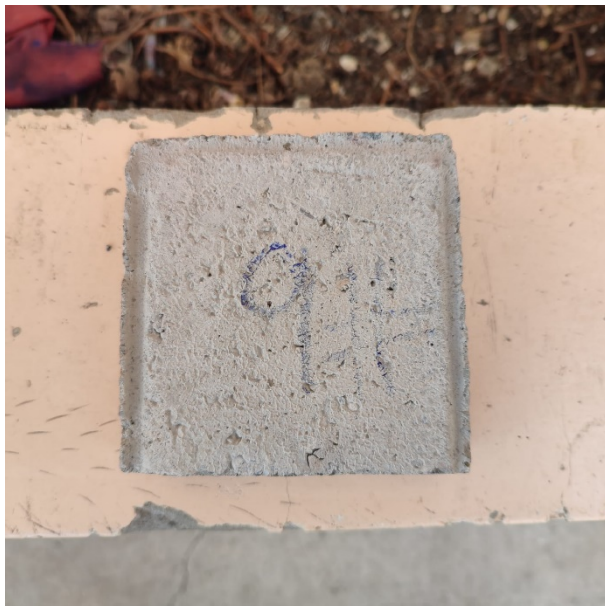
Anexo 16. Muestra de adoquín para ensayos al desgaste de abrasión, con dimensiones 10*10*3 cm
