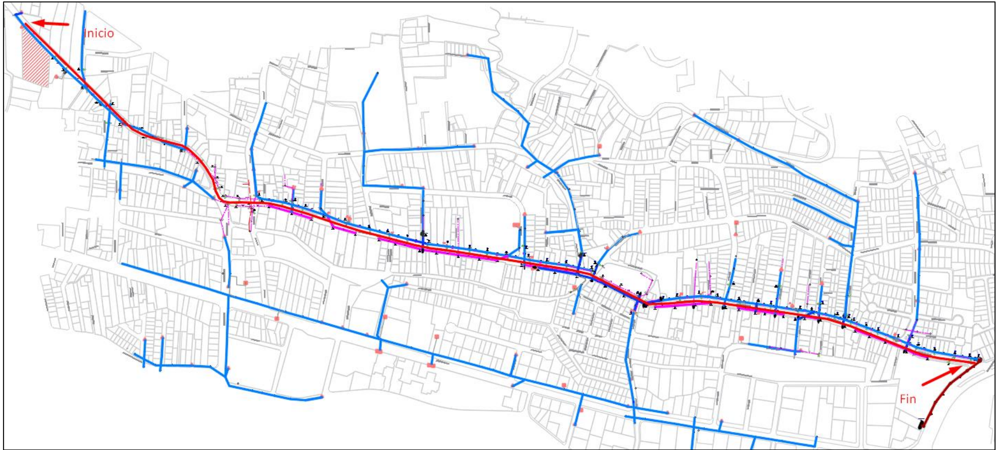
Ilustración 84: Alimentador 1722 de la subestación proyectada de Los Cerezos. Fuente: Autor.
