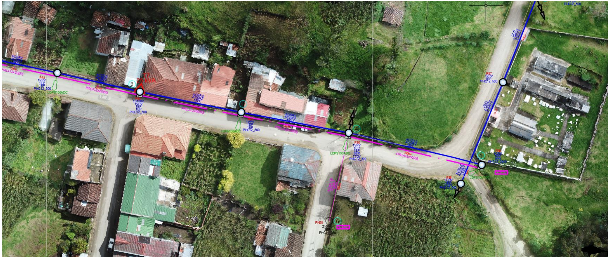
Ilustración 90: Sección de diseño de la red proyectada de Chumblin – Cisne – Liquiña con ortofoto Fuente: Autor.
