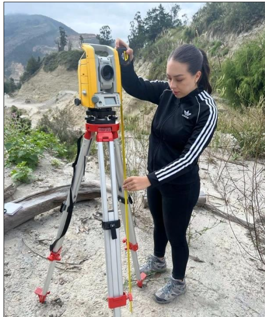
Figura 33. Medición de la altura del equipo en campo. Fuente: Autor.
