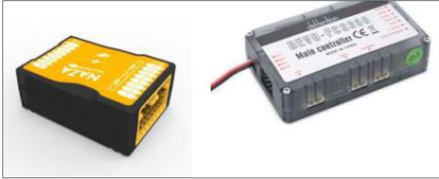
Figura 23. Tipos de controladores de vuelo de los RPAs. Fuente: [15]
