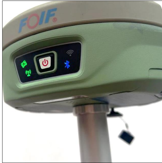
Figura 43. Comprobación de la conexión del receptor móvil al encenderse la luz del Bluetooth. Fuente: Autoría.
