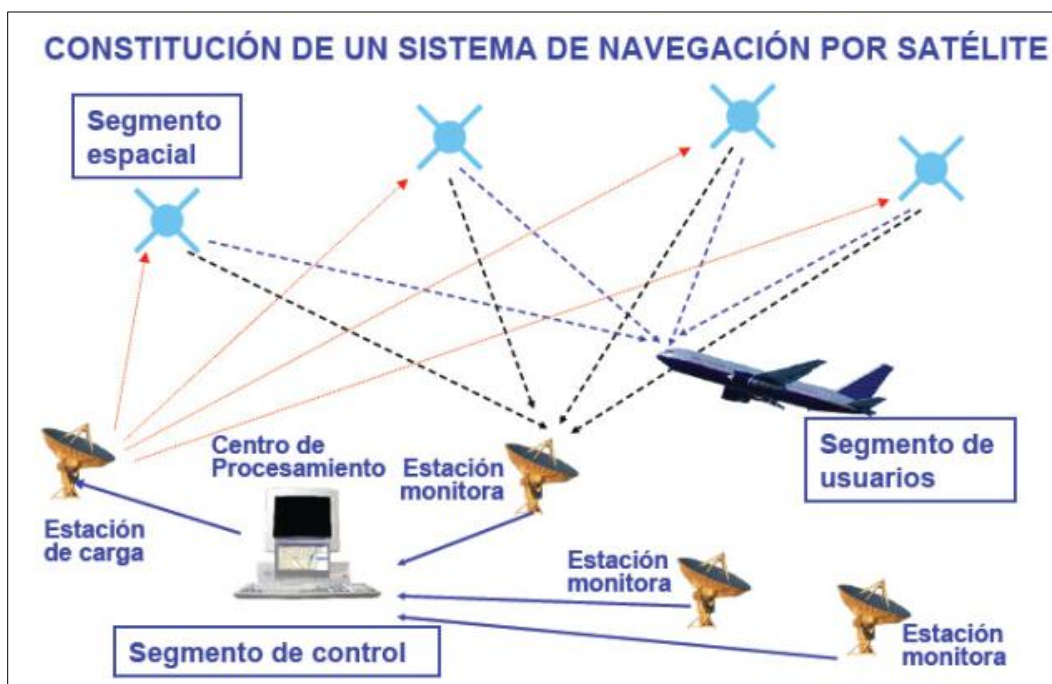
Figura 9. Funcionamiento del GNSS. Fuente: [9]
