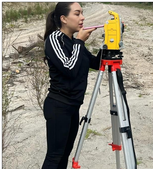
Figura 34. Toma del Norte con la Estación Total desde un dispositivo móvil. Fuente: Autor.
