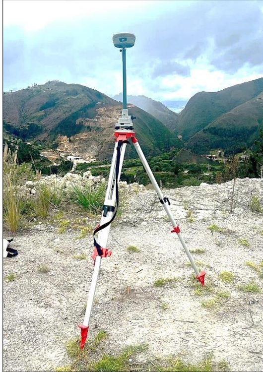
Figura 40. Receptor base nivelado y centrado en la mina "Colina Verde". Fuente: Autoría.
