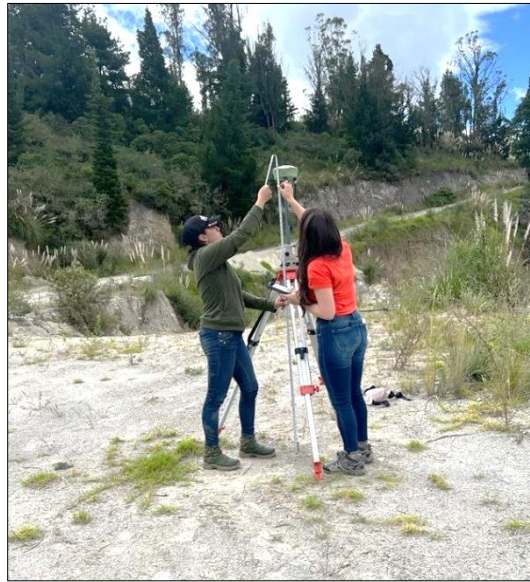
Figura 42. Verificación de la altura del sistema RTK con un flexómetro. Fuente: Autoría.
