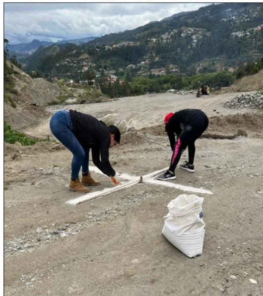
Figura 46. Señalización de los puntos de control (GCP). Fuente: Autoría.
