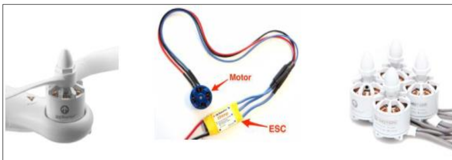
Figura 20. Motor, hélices y controlador de velocidad. Fuente: [15]
