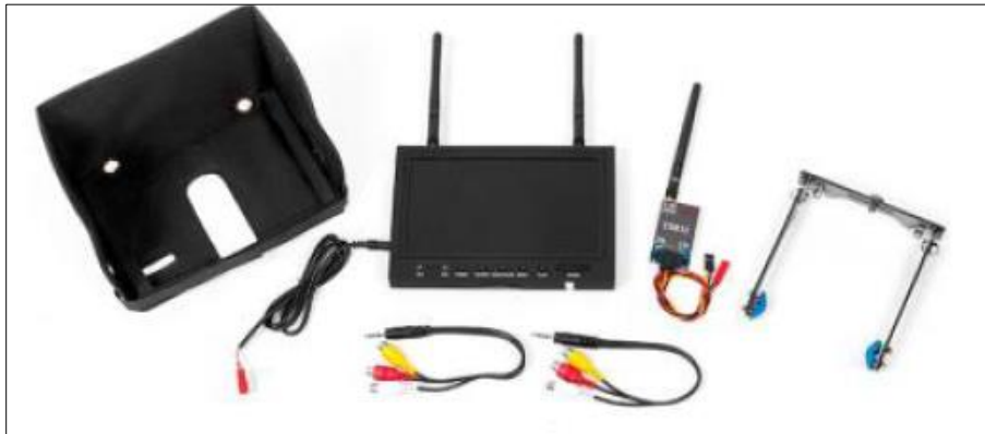
Figura 26. Ejemplo de un sistema de emisión y recepción para el manejo de un RPAs mediante FPV. Fuente: [15]
