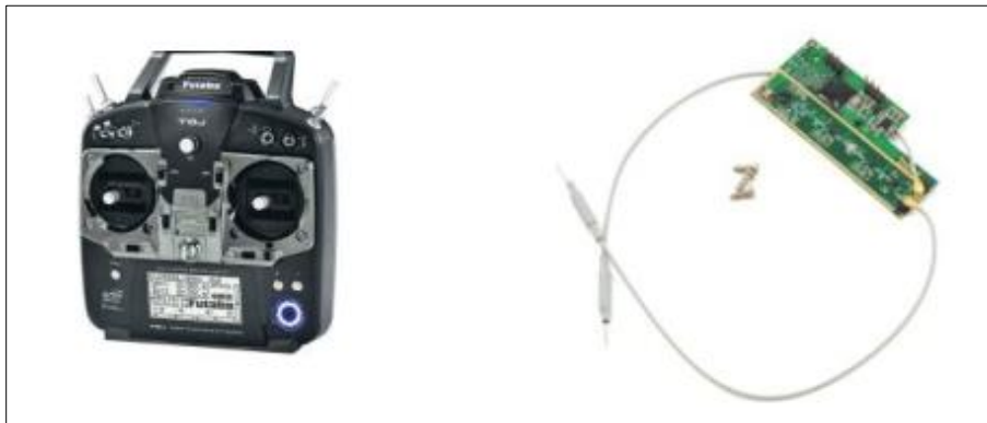
Figura 24. Un ejemplo de un control y un receptor de un RPAs. Fuente: [15]
