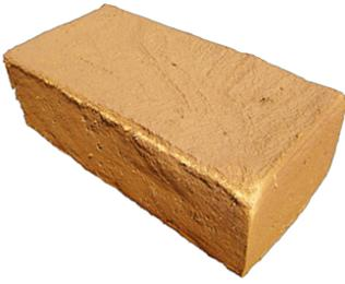
Se presenta como un bloque macizo de tierra, al mismo que se le puede agregar elementos que ayuden a su estabilización para así llegar a la optimización del material. A diferencia de otros elementos empleados en mamposterías, los bloques de adobe se secan al estado natural además de poseer una plasmación sencilla.
