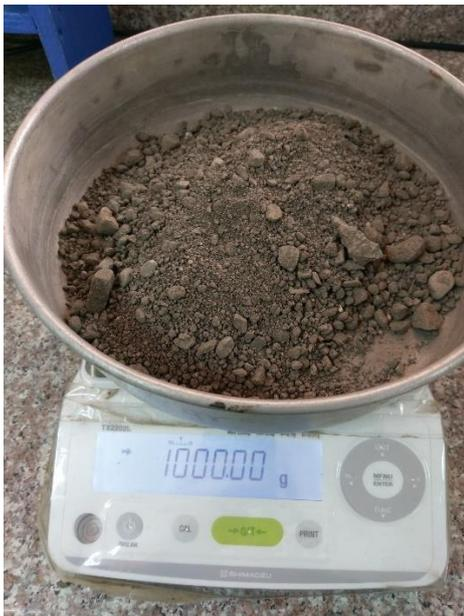
Figura 44. Toma de muestra para ensayo granulométrico.
