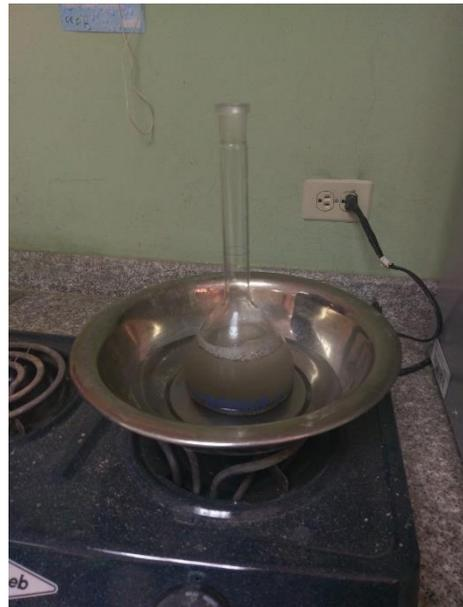
*Figura 47. Ejecución de ensayo mediante el uso de picnómetro.*
