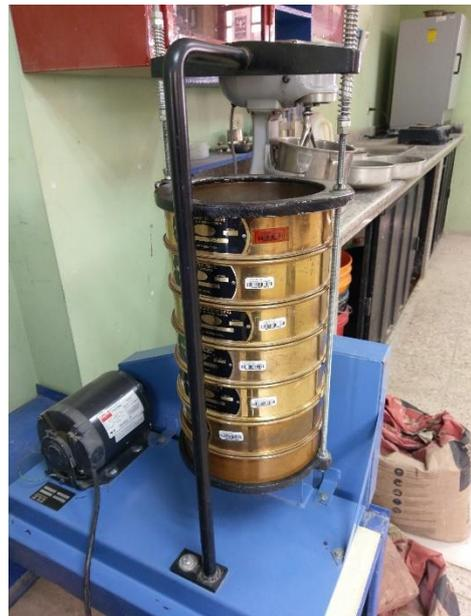
Figura 45. Tamizado de material en laboratorio.
