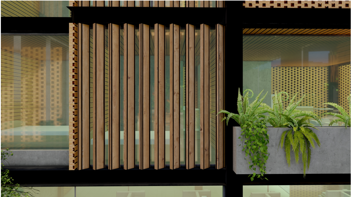
FIGURA 3.24: Sistema de lamas de madera móviles en las fachadas. Fuente y elaboración: Autores
