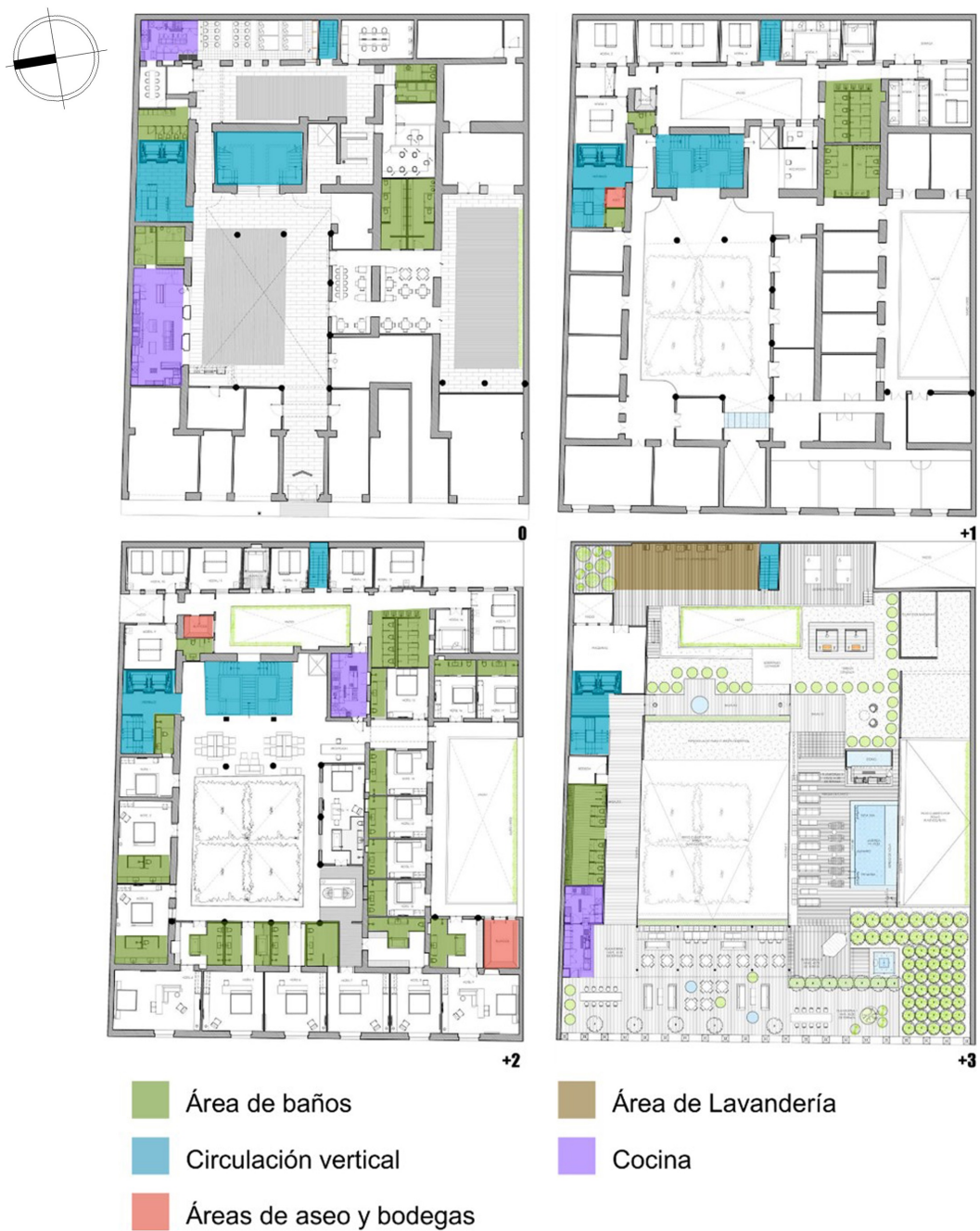
FIGURA 2.130: Área de baños y circulación vertical en el bloque A. Fuente: Plataforma arquitectura. Elaboración: Autores
