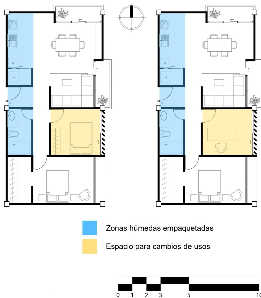
FIGURA 3.10: Cambios de usos en los espacios y zonas húmedas empaquetadas. Fuente y elaboración: Autores
