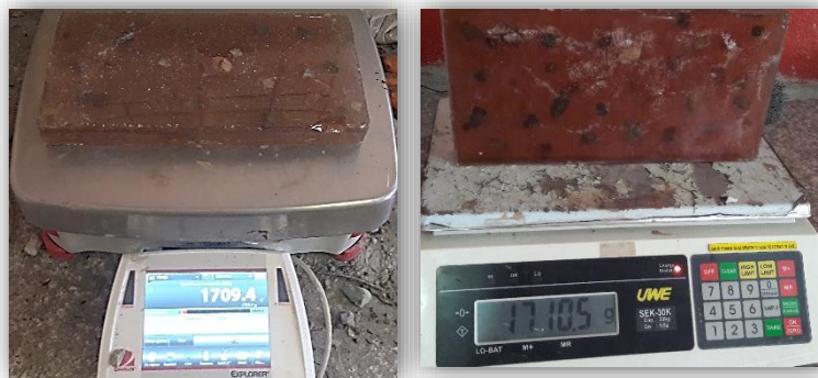
Figura 75. Peso Muestra Seca y Sumergida – Probeta # 3 de Hormigón (1%) + Resina (99%).
