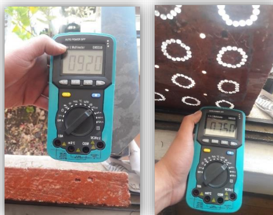
Figura 77. Medición de luz Incidente y luz Transmitida de la Muestra N°2 [Hormigón (91,75%) + Fibra Óptica (8,25%) con Fuente de luz Natural].
