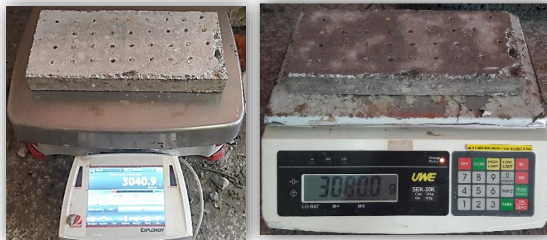
Figura 74. Peso Muestra Seca y Sumergida – Probeta # 3 de Hormigón + Fibra Óptica (Con Recubrimiento).
