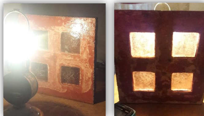
Figura 82. Proyección de haz de luz en la Cara Incidente y Transmisión de luz en la Cara Opuesta de la Muestra N°4 [Propuesta de Prototipo con una Fuente de luz Artificial]. Fuente: Autor, 2018.
