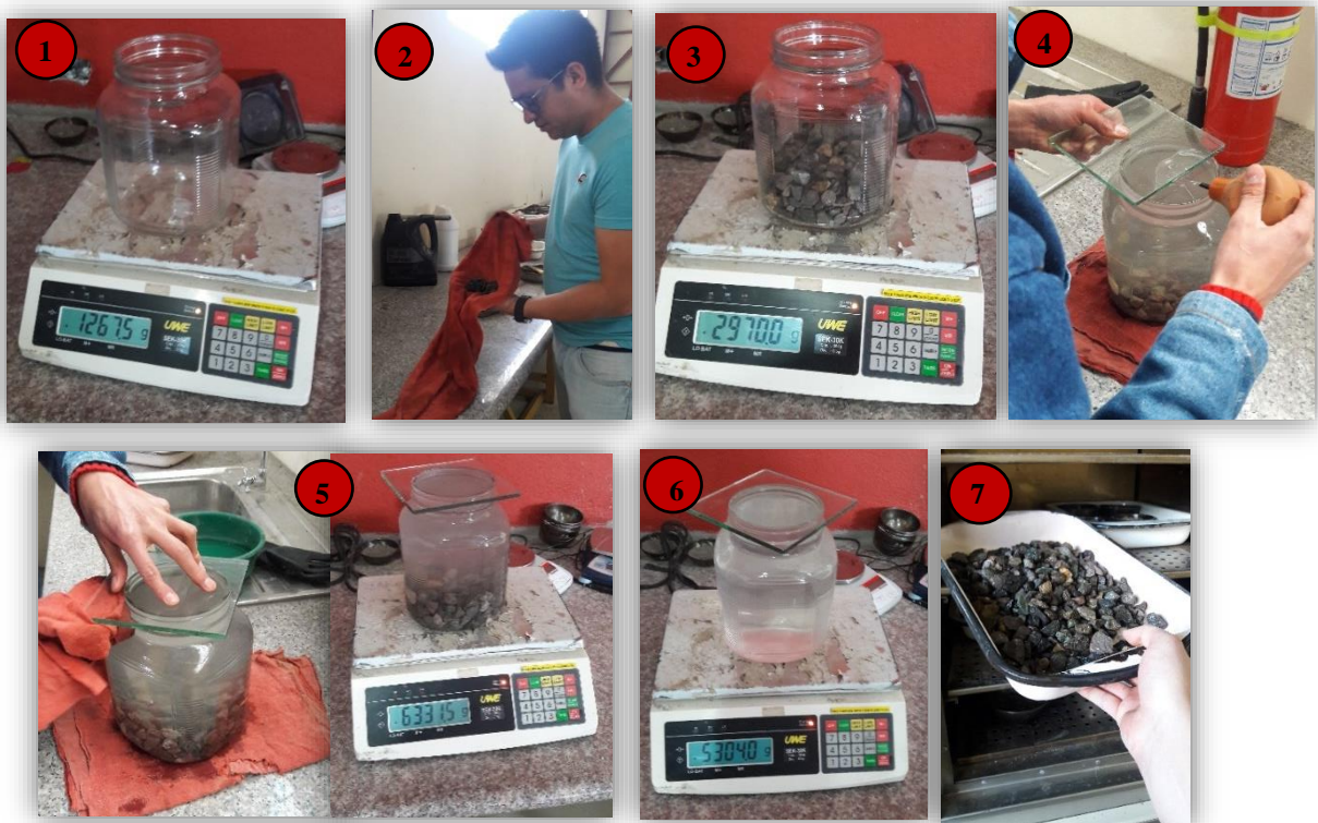
Figura 23. Procedimiento Para el Peso Específico de la Grava.
