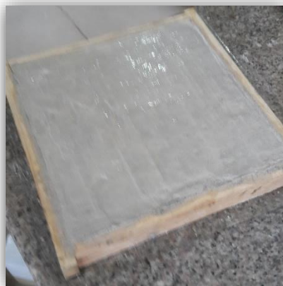
Figura 48. Muestra Alisada con Llana (Poros de Fibra Óptica Cubiertos).
