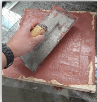
Figura 58. Muestra Alisada con Llana (Poros de Fibra Óptica Cubiertos).
