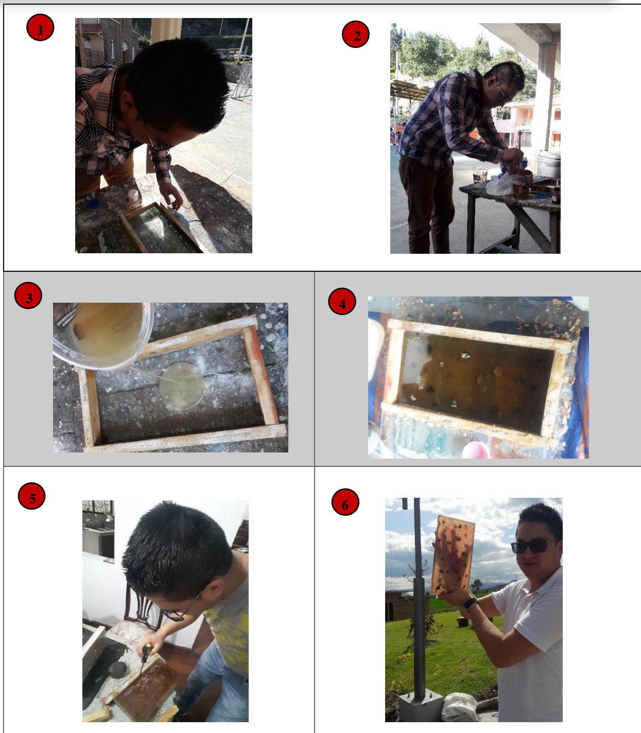
Figura 39. Procedimiento Para la Elaboración de la Muestra de Resina + Hormigón.
