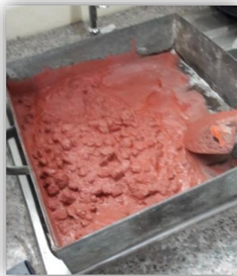
Figura 56. Mezclado del Hormigón.
