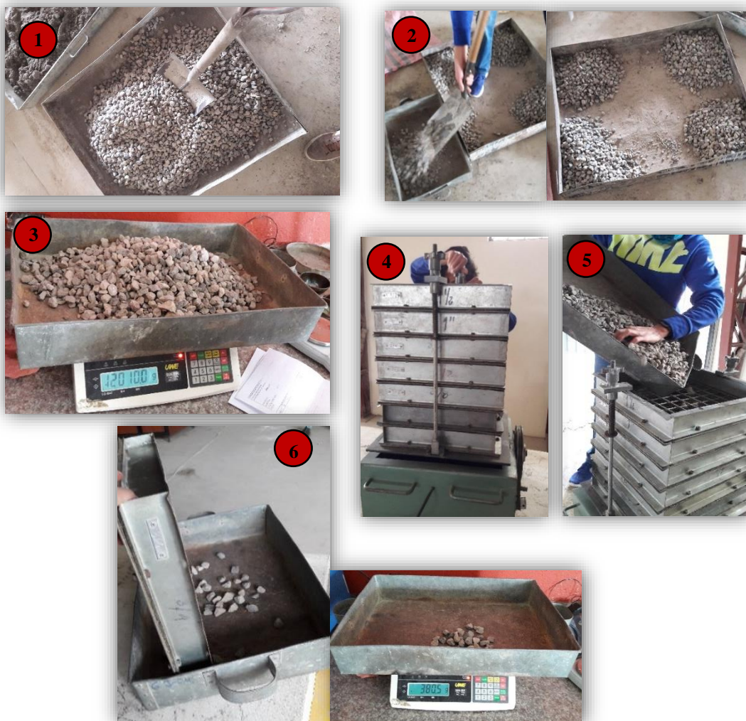
Figura 22. Procedimiento Para el Cálculo Granulométrico de la Grava.
