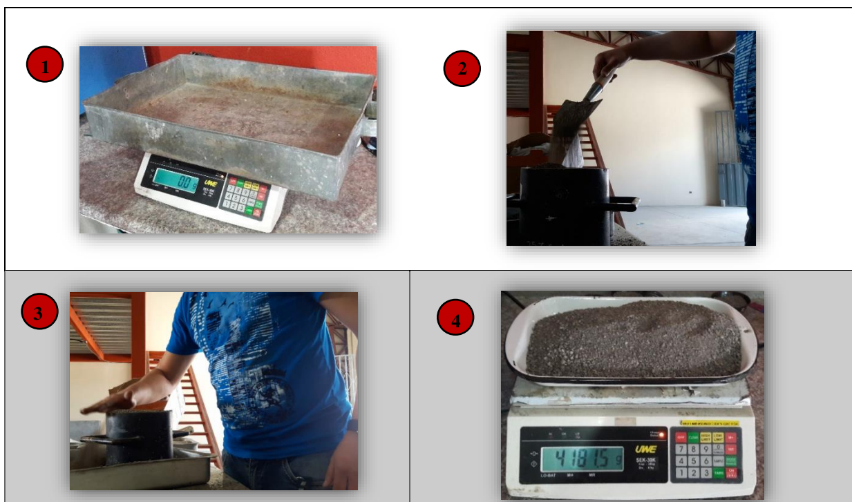
Figura 28. Procedimiento Para el Peso Volumétrico (Arena Suelta).
