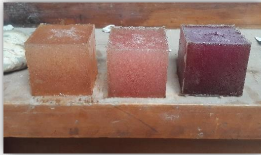
Figura 31. Cubos de Resina Poliéster Desencofrados.
