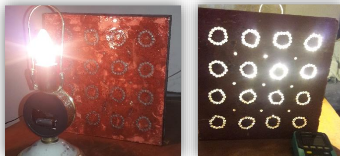
Figura 80. Proyección de haz de luz en la Cara Incidente y Transmisión de luz en la Cara Opuesta de la Muestra N°2 [Hormigón (91,75%) + Fibra Óptica (8,25%) con una Fuente de luz Artificial].
