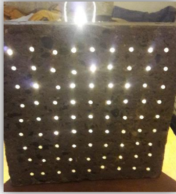
Figura 81. Transmisión de luz en la Cara Opuesta de la Muestra N°1 [Hormigón (97,5%) + Fibra Óptica (2,5%) con una Fuente de luz Artificial]. Fuente: Autor, 2018.
