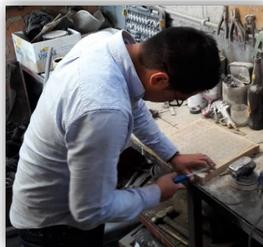
Figura 50. Desencofrado de la Muestra.
