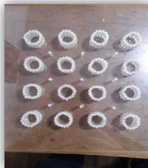
Figura 55. Colocado de la Fibra Óptica en la Base de Vidrio.
