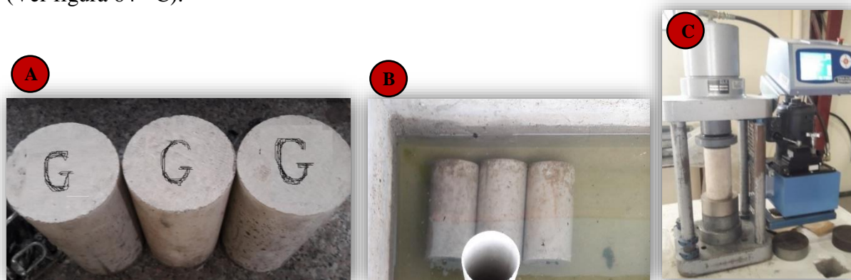
Figura 64. Ensayo a la Compresión de las Probetas Cilíndricas de Hormigón - Método Gráfico.
