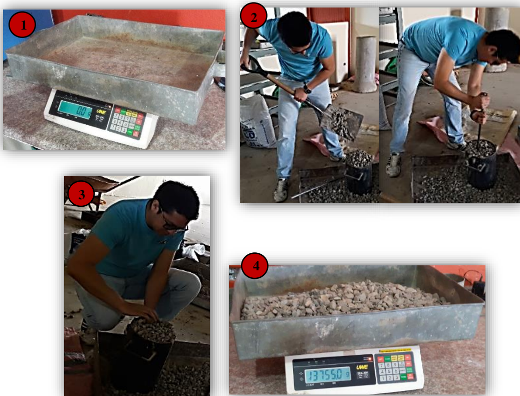
Figura 25. Procedimiento Para el Peso Volumétrico (Grava Compactada).
