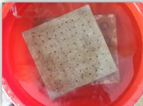
Figura 76. Muestras Finales Sumegidas previo al Ensayo de Absorción.
