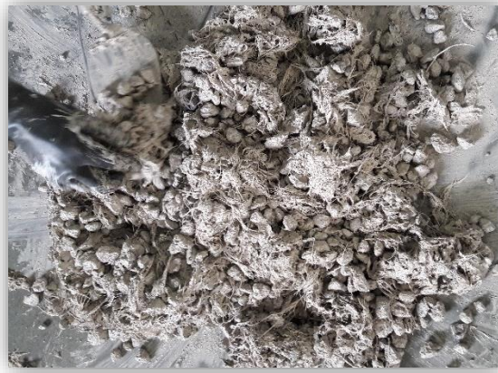
Figura 33. Masa Obtenida de la Mezcla de Hormigón + Fibra de Vidrio.
