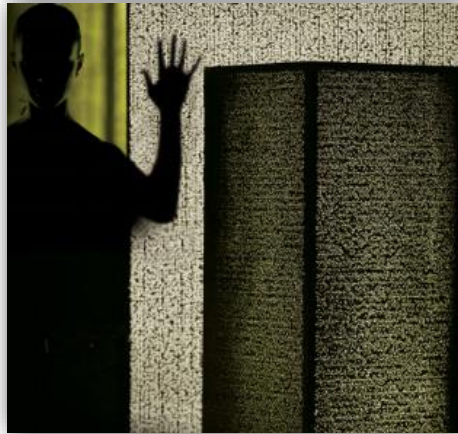
Figura 2. Muro de Hormigón Translúcido LUCCON
