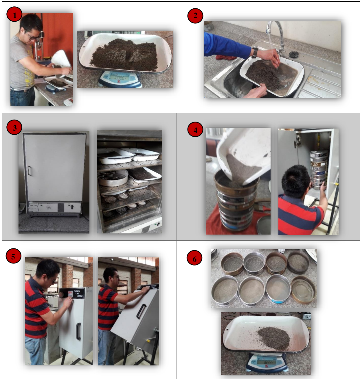
Figura 26. Procedimiento Para el Cálculo Granulométrico de la Arena.
