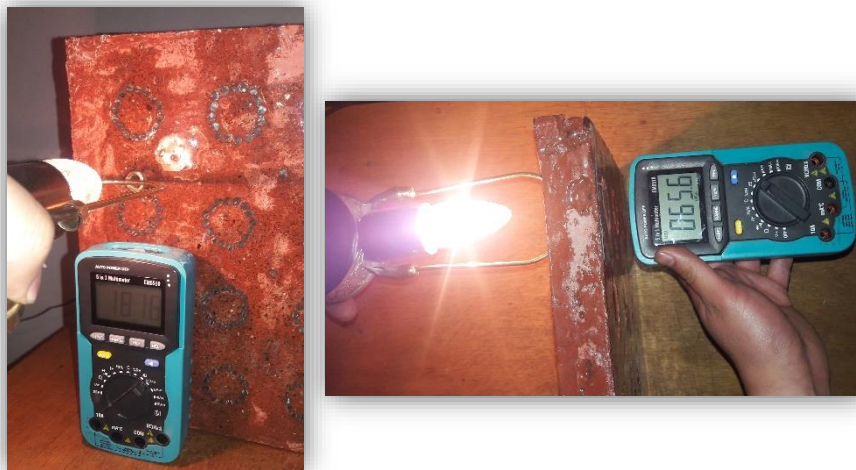
Figura 79. Medición de luz Incidente y luz Transmitida de la Muestra N°2 [Hormigón (91,75%) + Fibra Óptica (8,25%) con una Fuente de luz Artificial].
