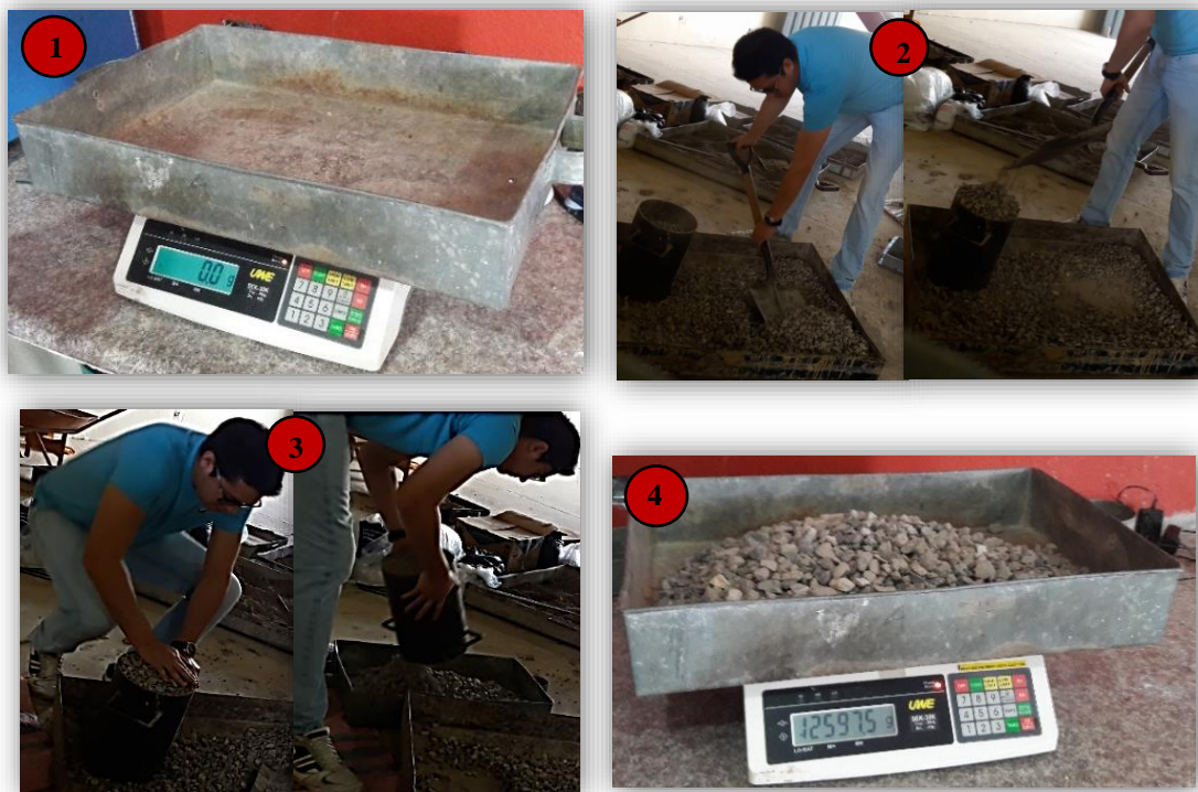
Figura 24. Procedimiento Para el Peso Volumétrico (Grava Suelta).
