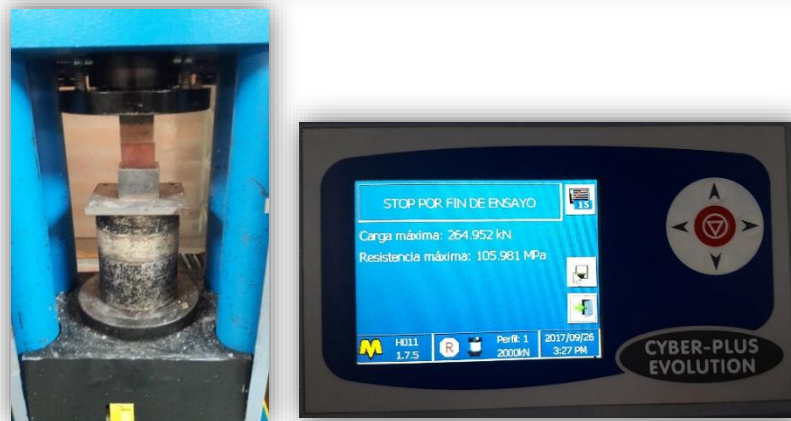
Figura 65. Rotura del Cubo # 3 de Resina Poliéster
