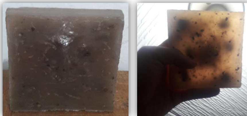
Figura 37. Probeta obtenida de la dosificación H°(5%) y R (95%).
