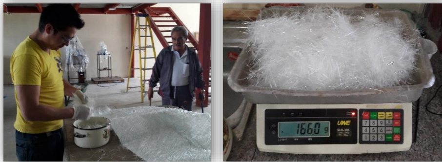
Figura 32. Desmembramiento y Pesado de la Fibra de Vidrio.
