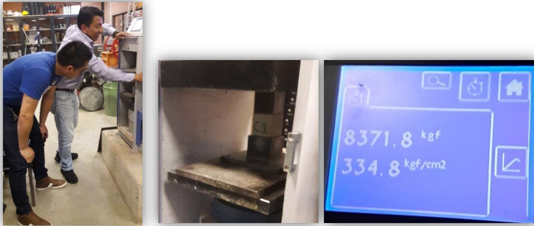
Figura 68. Rotura Probeta #4 de Hormigón (60%) + Resina (40%).
