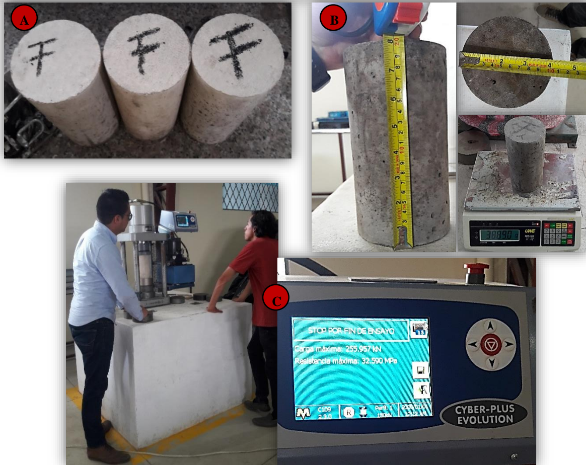
Figura 63. Ensayo a la Compresión de las Probetas Cilíndricas de Hormigón- Método de Fuller.
