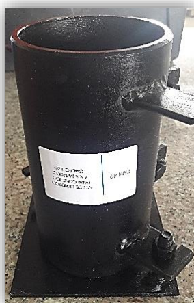
Figura 21. Molde Cilíndrico para Concreto (100 x 200mm).
