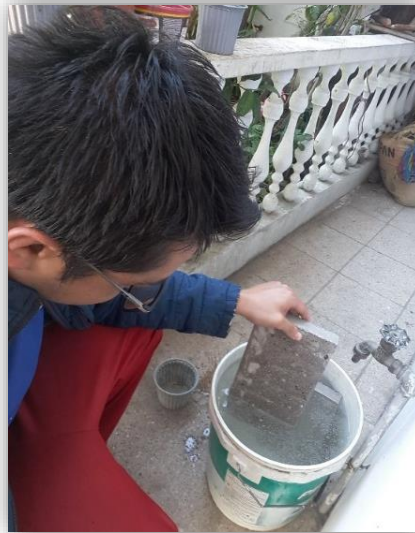
Figura 43. Curado de la Muestra.
