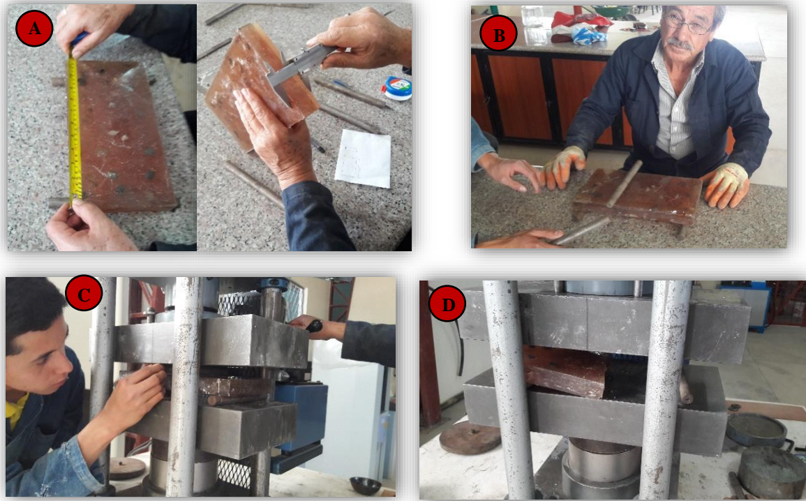
Figura 72. Proceso de Ensayo a la Flexión de Probetas - Hormigón + Resina.
