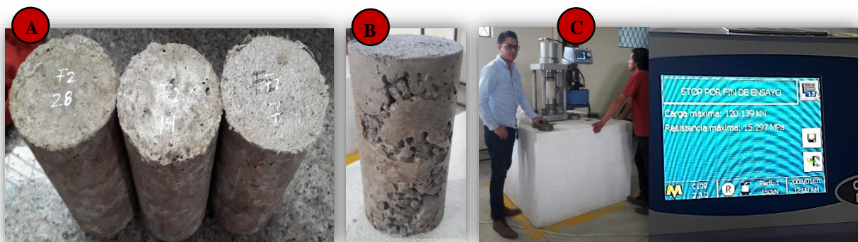
Figura 66. Probetas Cilíndricas de Hormigón + Fibra de Vidrio (Método de Fuller).
