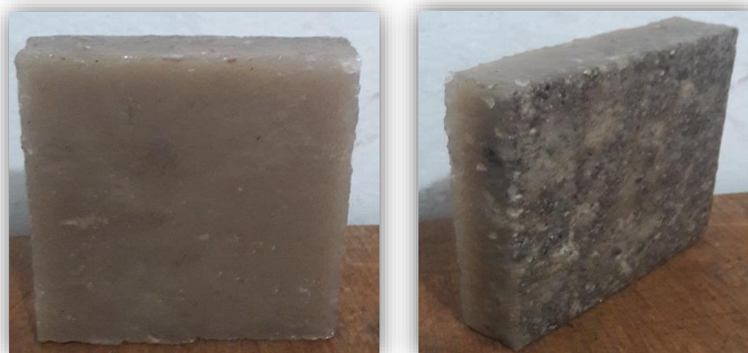
Figura 35. Probeta obtenida de la dosificación H o (10%) y R (90%).
