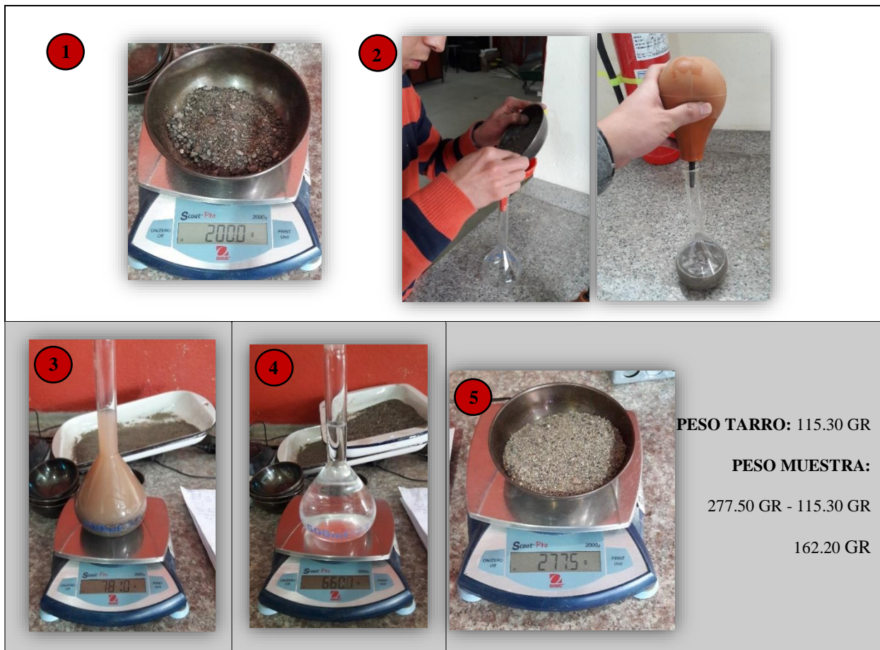
Figura 27. Procedimiento Para el Peso Específico de la Arena.
