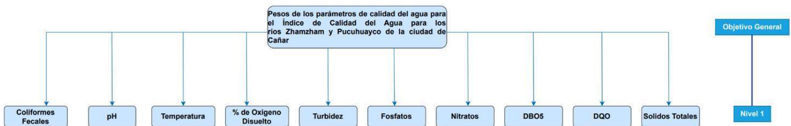
Figura 34. Estructuración de la jerarquía para la determinación de los pesos del AHP. Fuente: Elaboración propia.
