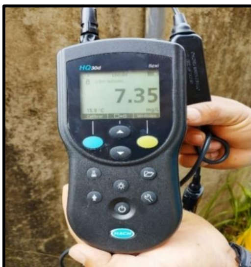
Anexo 5: Multiparamétrico de marca flexi HQ 30d.
