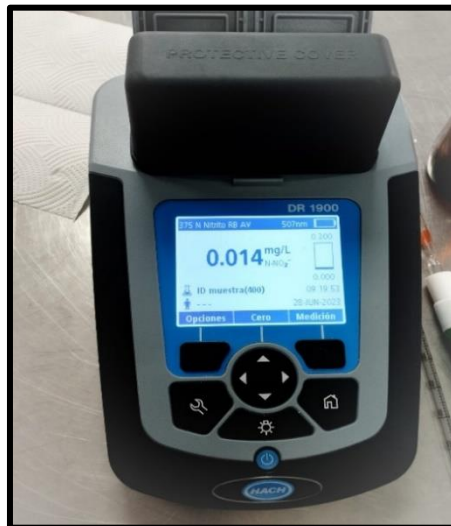
Anexo 10: Equipo de espectrofotetría HACH DR/1900
