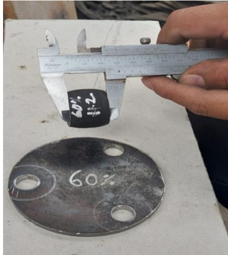
Figura 19: Medición de probetas al finalizar la prueba de compresión
