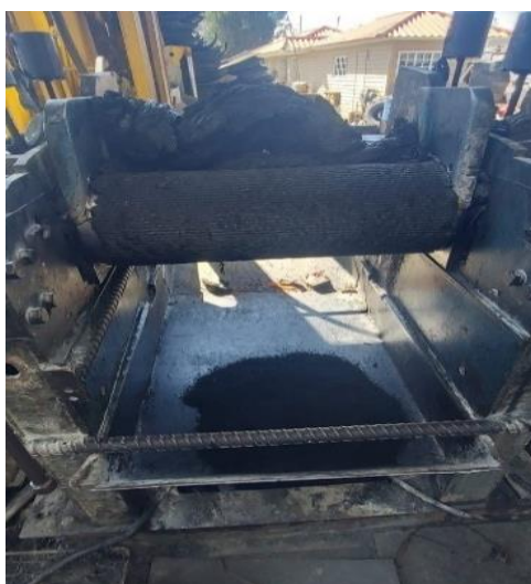
Figura 7: Mezcla de materiales en el molino a cielo abierto.
