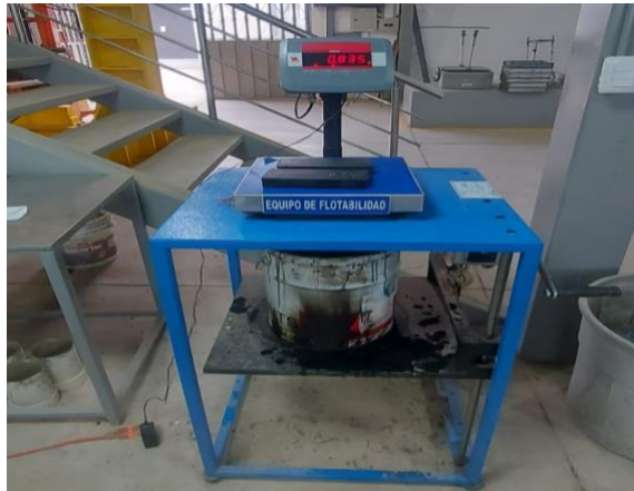
Figura 24: Levantamiento de datos de peso en aire de la muestra saturada superficialmente seco
