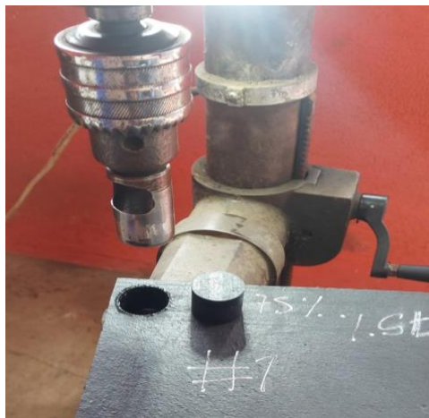
Figura 15: Extracción de probetas circulares tipo 2.
