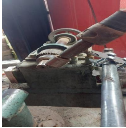
Figura 20: Torno para la prueba de abrasión de probetas de caucho
