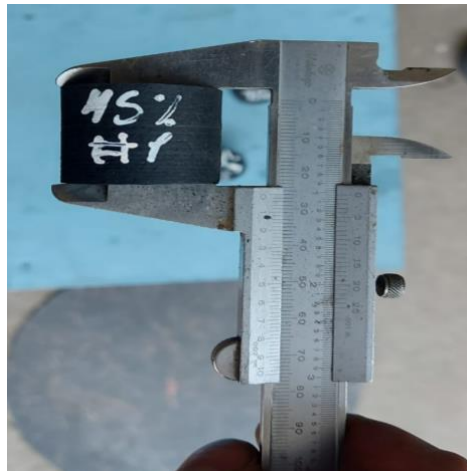
Figura 17: Medición Inicial de probetas.
