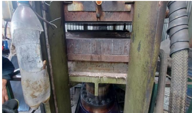
Figura 10: Prensado y vulcanizado de revestimientos
