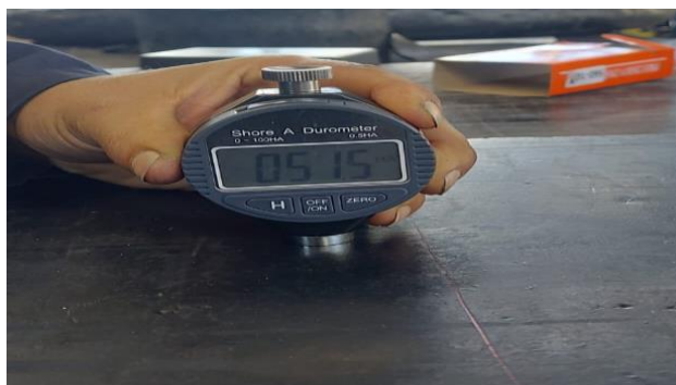
Figura 12: Toma de datos de dureza de los revestimientos
