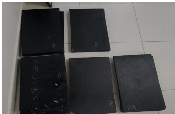
Figura 11: Curado de revestimientos
