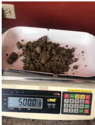
Ilustración 46: Ensayo granulométrico muestra 5
