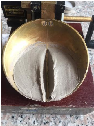
Ilustración 54: Ensayo límite líquido muestra 3 Fuente: Los Autores
