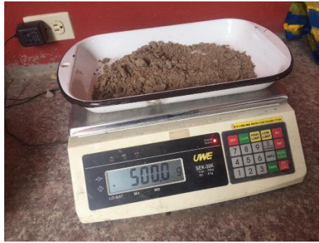
Ilustración 45: Ensayo granulométrico muestra 2
