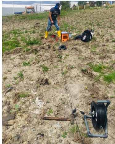
Ilustración 79: Levantamiento de SEV 4 Fuente: Los Autores
