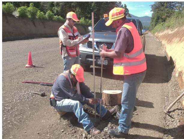
Ilustración 6: Uso del cono dinámico en pavimentos Fuente: CM Ingenieros S.A.
