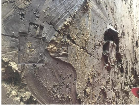
Ilustración 66: Toma de muestras para ensayo de corte directo calicata 2 Fuente: Los Autores
