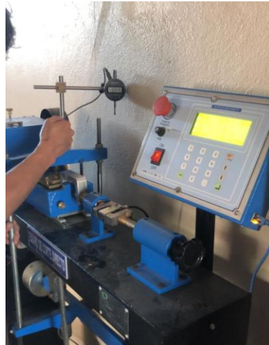
Ilustración 66: Toma de muestras para ensayo de corte directo calicata 2 Fuente: Los Autores
