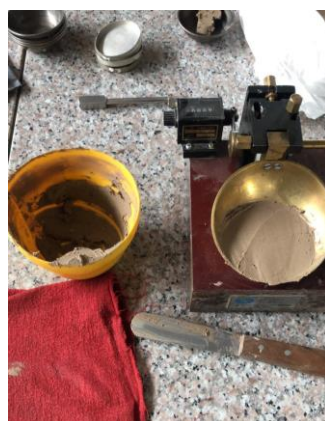
Ilustración 53: Ensayo de límite líquido muestra 2
