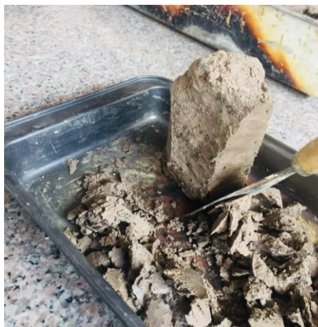
Ilustración 70: Preparación de la muestra para ensayo triaxial Fuente: Los Autores
