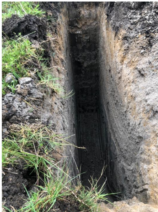
Ilustración 8: Calicata donde se aprecia la estratigrafía Fuente: Los Autores
