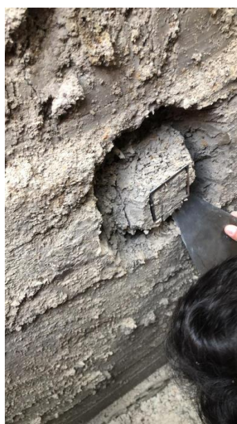
Ilustración 43: Muestra inalterada calicata 2
