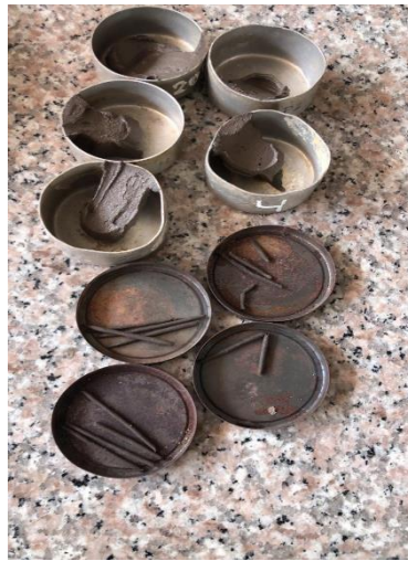
Ilustración 60: Ensayo límite plástico muestra 4 Fuente: Los Autores
