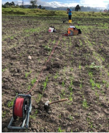
Ilustración 78: Levantamiento de SEV 5 Fuente: Los Autores
