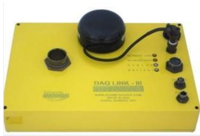
Ilustración 11: Sismógrafo DAQ LINK III utilizado para el método ReMi Fuente: Geoseismic
