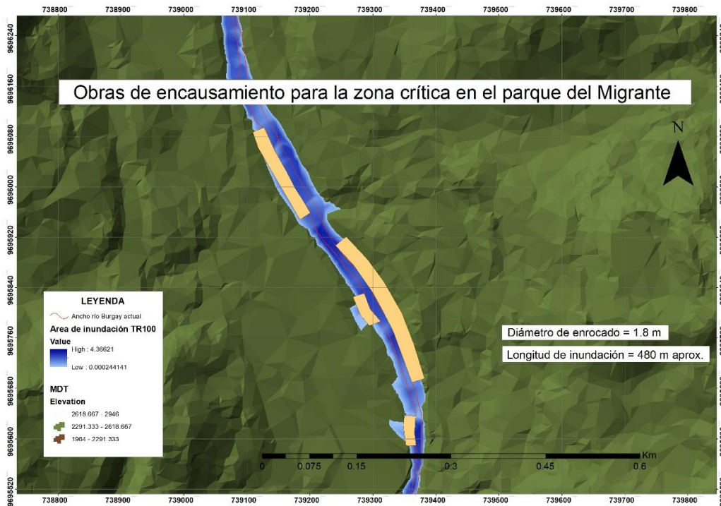
Ilustración 40. Obras de encauzamiento, parque Migrante. Fuente: Elaboración propia.
