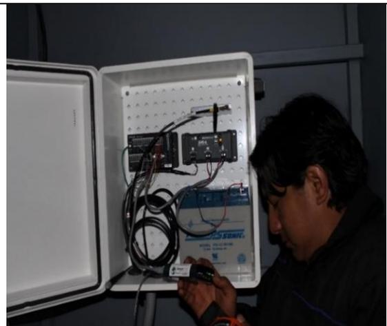
**Foto 4:** Técnico realizando la revisión de conexiones y transmisión de Modem GPRS
