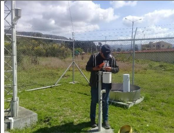
**Foto 1:** Técnico de mantenimiento realizando limpieza y verificación de señal del Pluviógrafo.
