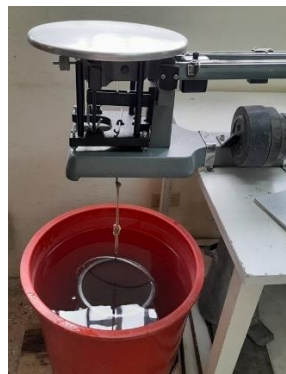
Masa del árido en canastilla y agua
