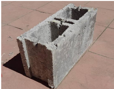
Bloque adición del 3% de fibra
