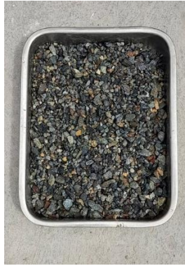
Eliminación de agua superficial
