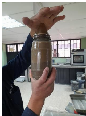
Picnómetro con muestra de árido y agua
