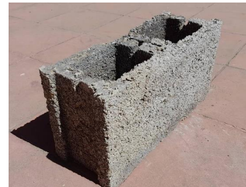
Bloque adición del 12% de fibra
