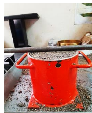
Nivelación de la superficie
