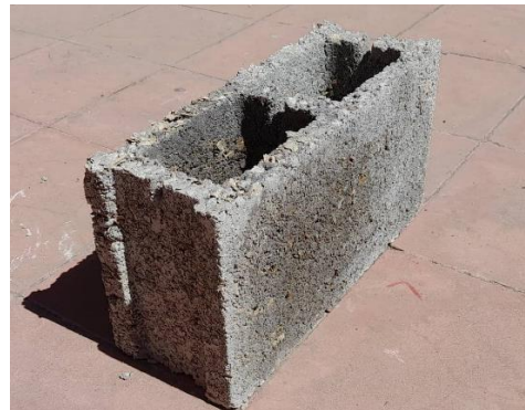
Bloque adición del 6% de fibra
