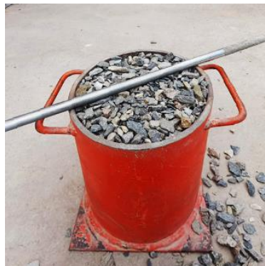
Nivelación de la superficie
