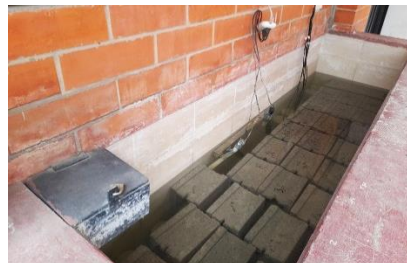
Curado de bloque en estanque
