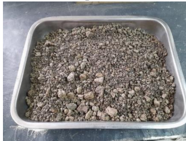
Eliminación de agua superficial
