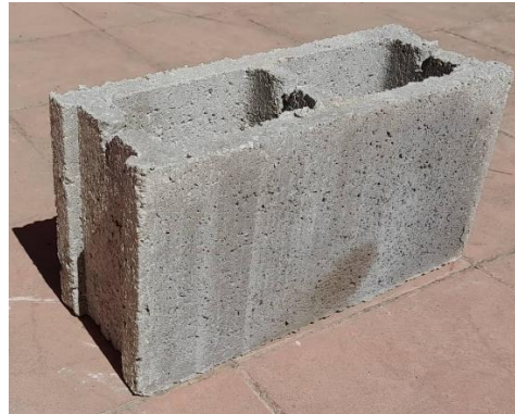
Bloque de hormigón (patrón 1)
