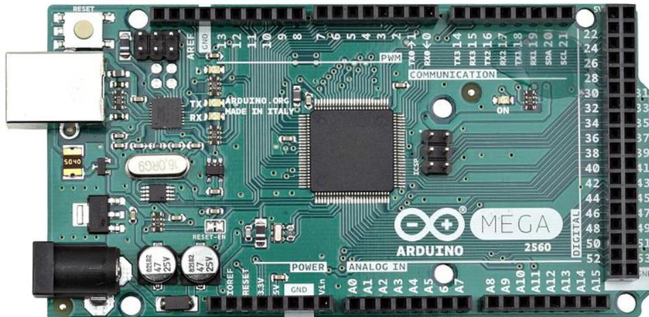
**Figura 8.** Placa Arduino Mega 2560.
