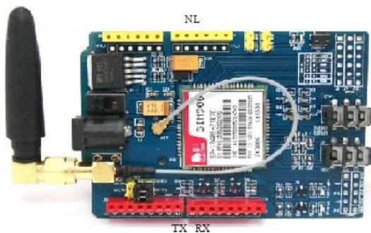
**Figura 9.** Tarjeta GSM/GPRS 900
