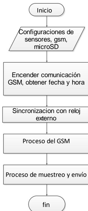
**figura 30.** Diagrama de flujo de la base receptora
