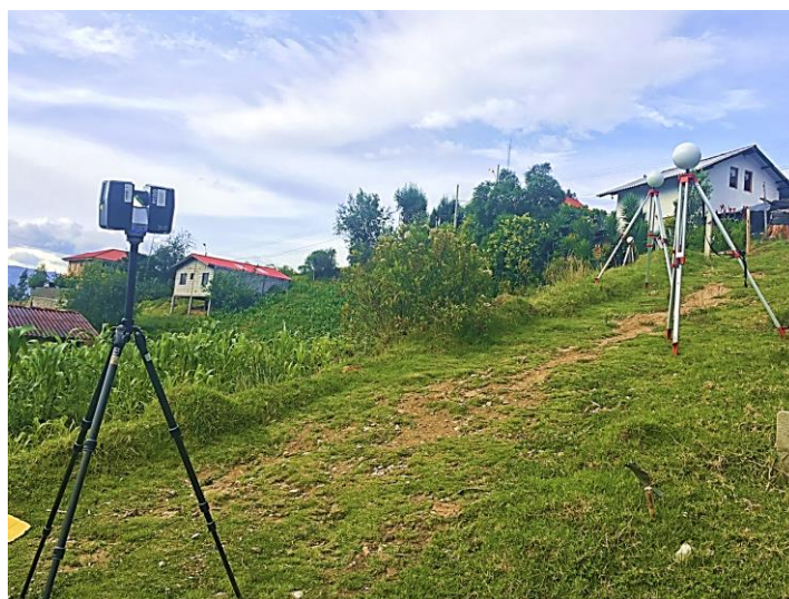
Figura 4-1. Levantamiento en la zona de interés mediante escáner FARO Focus3D X130
