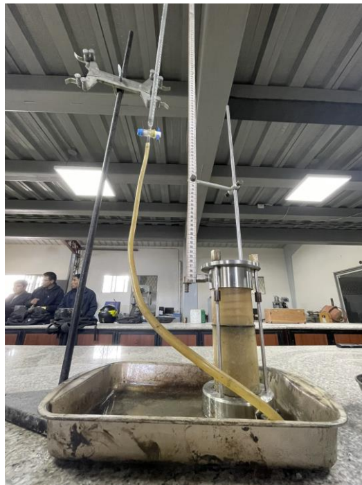
Figura 4-11. Ensayo de Permeabilidad
