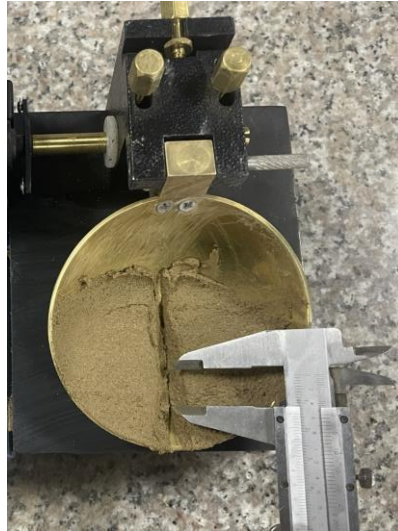
Figura 2-4. Ensayo para establecer el límite líquido usando la cuchara de Casagrande
