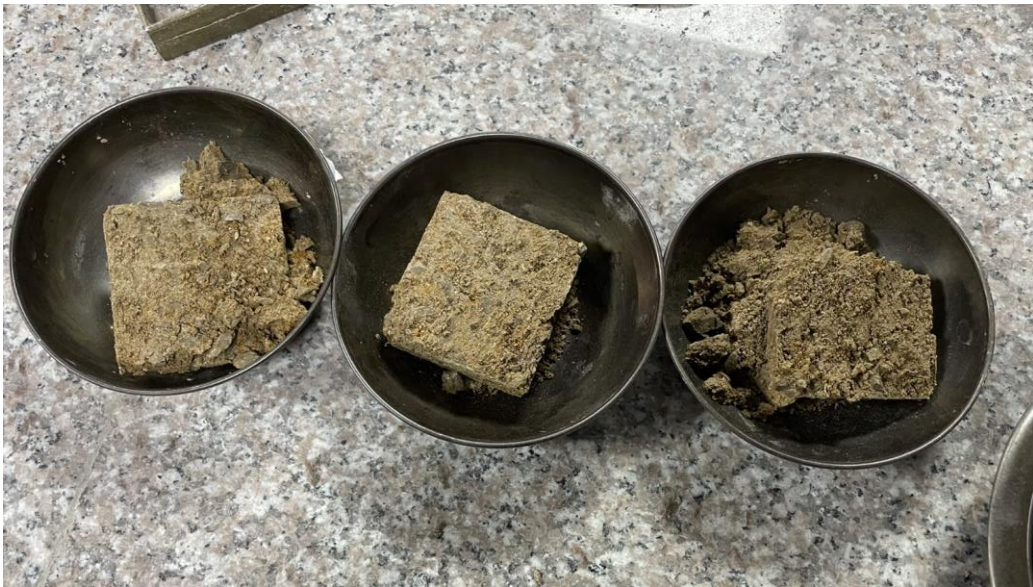
Muestras de ensayo de corte Directo luego de secado
