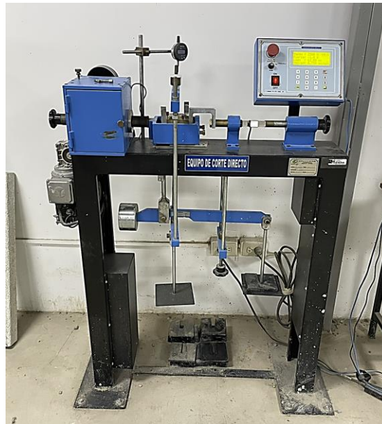
Figura 2-5. Maquina corte directo en el laboratorio de suelos de la Universidad Católica de Cuenca
