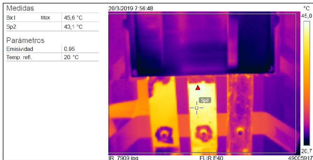
Fig. 7. 58 Foto de termografía en las tres fases del tablero de Transformador No.1
